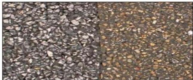
*Figura 17. Pulimiento de agregados*
