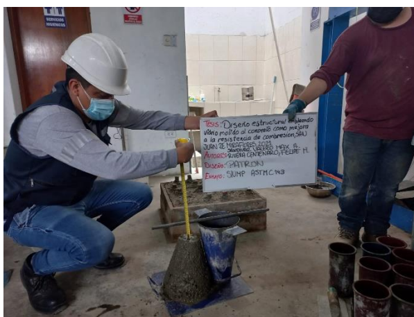
Figura 7. Ensayo Slump ASTM 143 – Patrón
