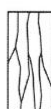
Tipo 3 Fisuras verticales encolumnadas a través de ambos extremos, conos no bien formados
