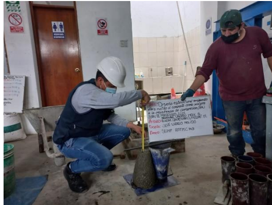
Figura 9. Ensayo Slump ASTM 143 – 30%
