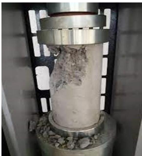
Figura 1: Ensayo a la compresión del concreto
