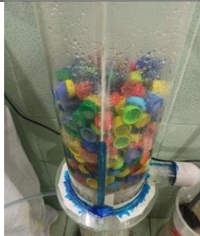
Figura 17. modulo instalado con material de retención (Autor propio)
