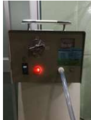
Figura 14. unión manguera y generador o3 (Autor propio)
