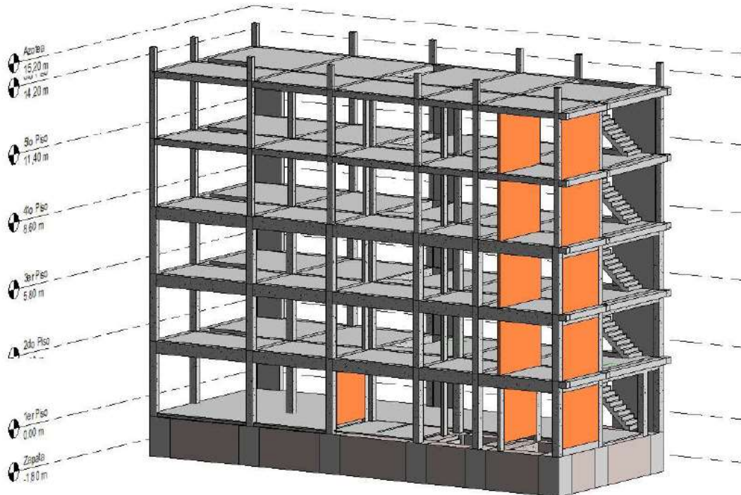
Figura 26 3D Estructura Albañilería Reforzada Fuente Propia
