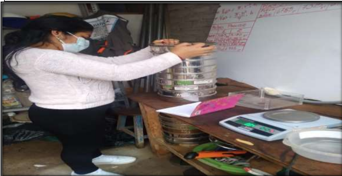
FOTO N°5: Se procedió a echar la muestra en la fila de tamices pasando por la malla N°04
