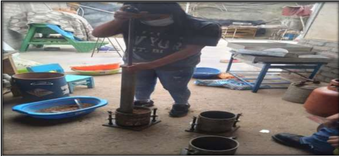
FOTO N°10: Proctor modificado, la muestra se depositó en un recipiente, luego se añadió porcentajes diferentes de agua, se pesó y se llevó al horno a secar, luego se sacó y se pesó, se determinó así el contenido de humedad. se procedió con la compactación de la muestra dando 56 golpes a las 5 capas, se niveló y se pesó, luego de desmoldo y se pesó.
