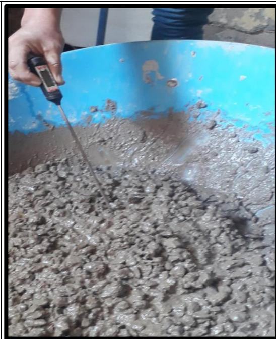
Ensayo de toma de temperatura de concreto con aditivo plastificante
