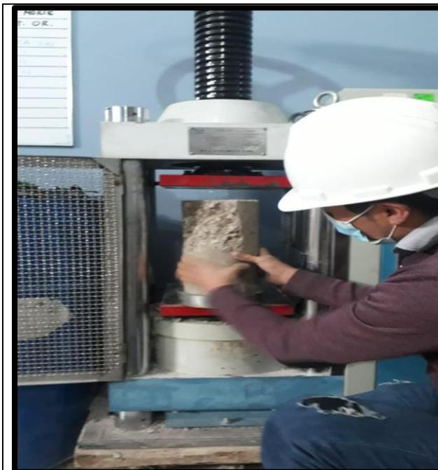
Ensayo resistencia a la compresión de concreto  $f'c = 210\text{kg/cm}^2$ , muestra diseño patrón
