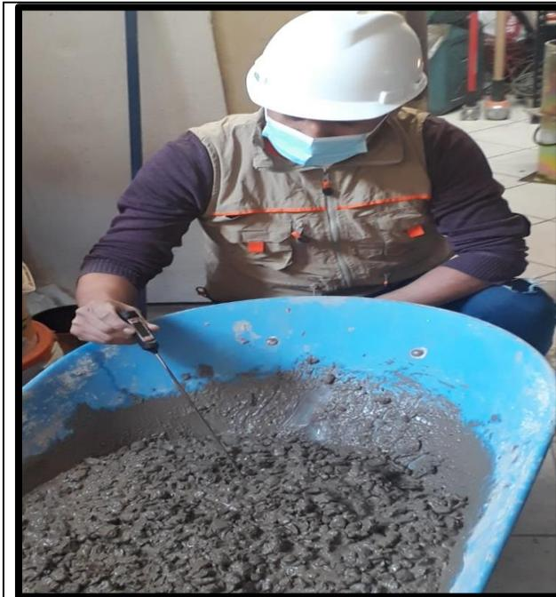
Ensayo de toma de temperatura de concreto patrón
