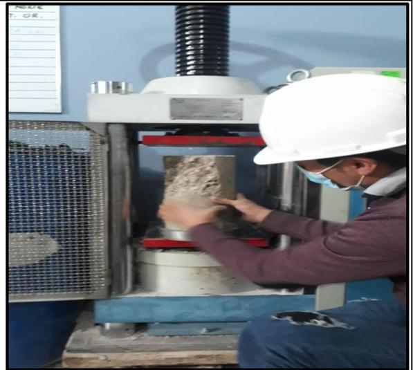
*Figura:9* Rotura de probetas a los 14 días
