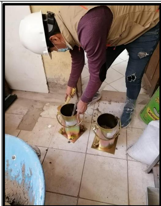
preparación de probetas de concreto con aditivo plastificante
