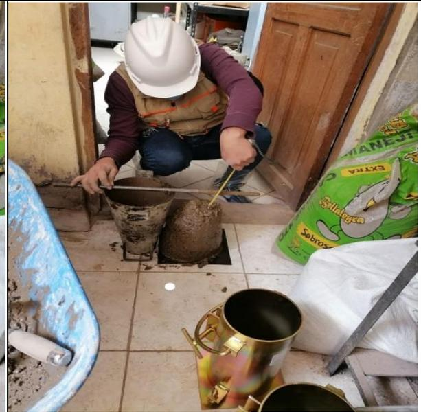
Figura 6 Medición del Asentamiento del concreto con aditivo plastificante
