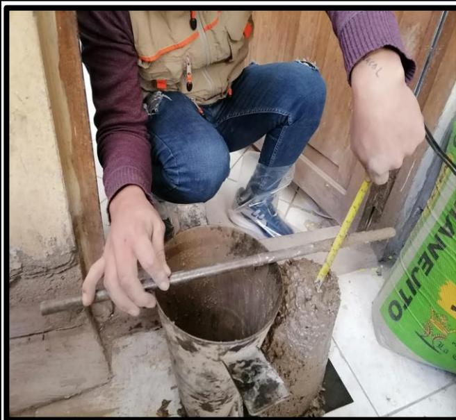
Ensayo del asentamiento del concreto patrón
