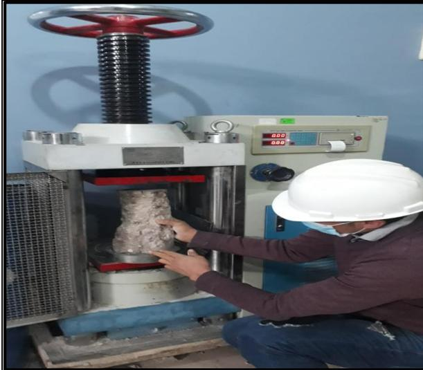
*Figura:8* Rotura de probetas a los 14 días
