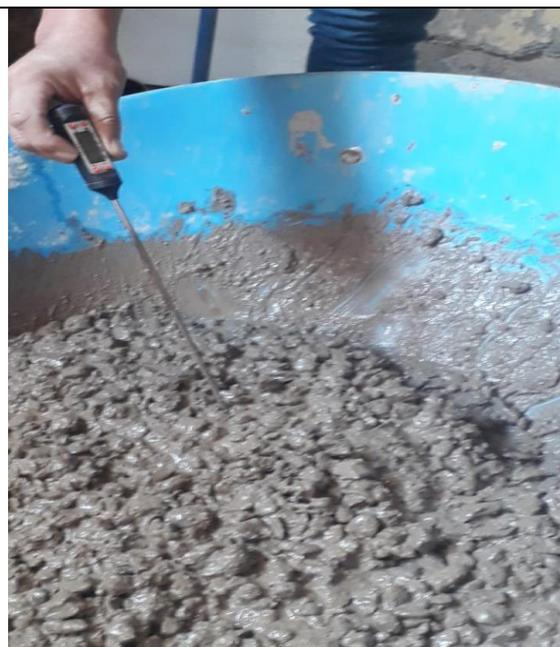
*Figura 12* Medición de temperatura del concreto incorporado con aditivo
