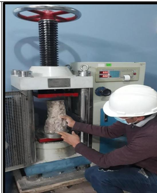
Ensayo resistencia a la compresión de concreto  $f'c = 210\text{kg/cm}^2$ , muestra diseño concreto con aditivo plastificante
