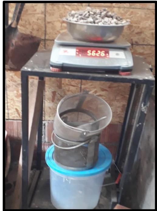
Peso específico agregado grueso
