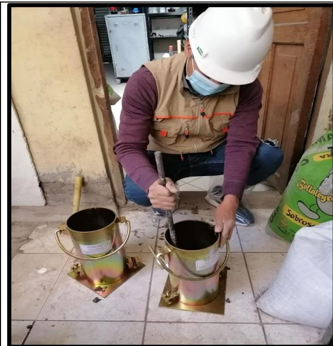
preparación de probetas de concreto patrón
