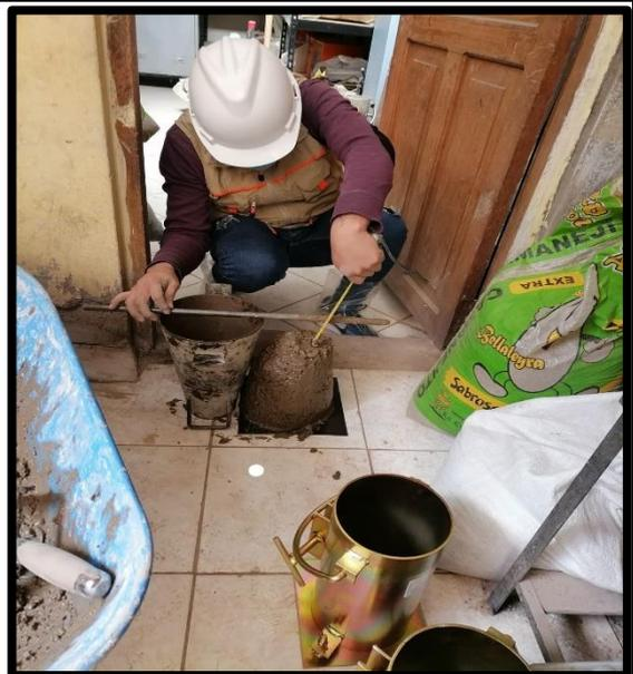
Ensayo del asentamiento del concreto con aditivo plastificante
