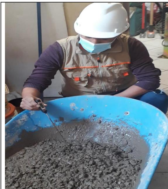
*Figura 11* Medición de temperatura del concreto patrón
