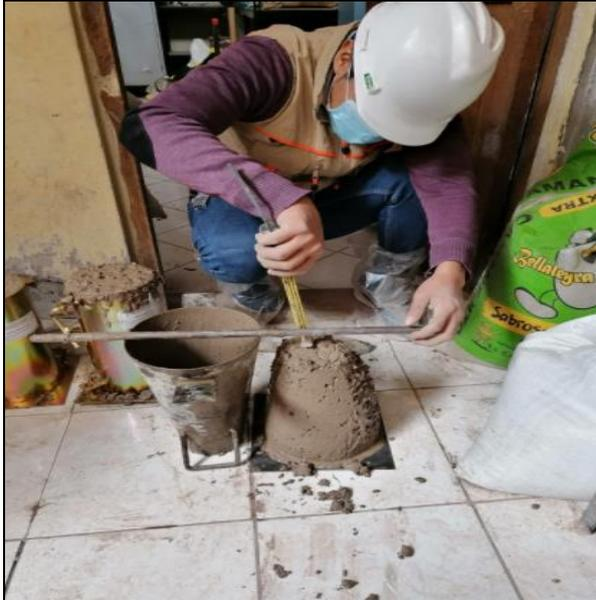
Figura 5 Medición del Asentamiento del concreto patrón
