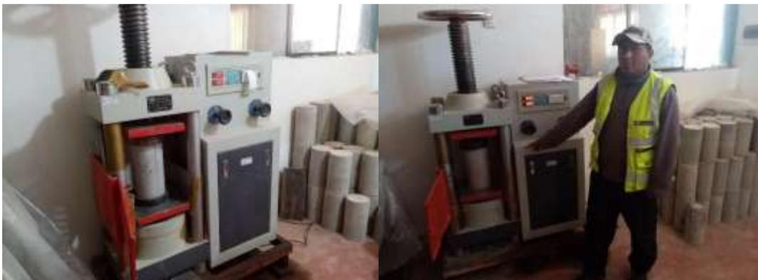
En el ensayo a compresión de las muestras de **concreto con adición del 5% de caucho**, como se evidencia en la siguiente tabla, presentaron una resistencia promedio de 145.44 kg/cm<sup>2</sup> a los 7 días, 167.72 kg/cm<sup>2</sup> a los 14 días, 187.91 kg/cm<sup>2</sup> a los 21 días y 197.34 kg/cm<sup>2</sup> a los 28 días, una resistencia a la compresión promedio de 197.34 kg/cm<sup>2</sup>.
