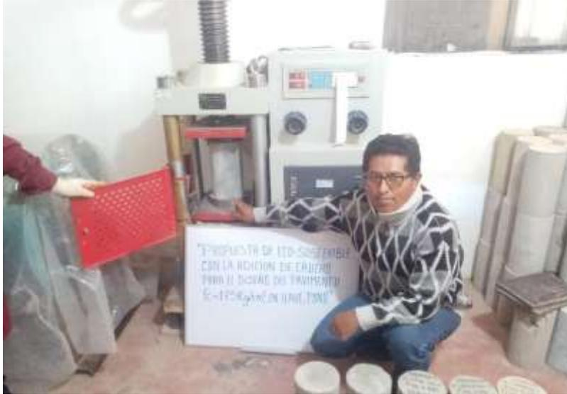
En el ensayo a compresión de las muestras de **concreto con adición del 10% de caucho**, como se evidencia en la siguiente tabla, presentaron una resistencia promedio de 140.67 kg/cm<sup>2</sup> a los 7 días, 164.23 kg/cm<sup>2</sup> a los 14 días, 182.61 kg/cm<sup>2</sup> a los 21 días y 28 días, una resistencia a la compresión promedio de 194.85 kg/cm<sup>2</sup>.
