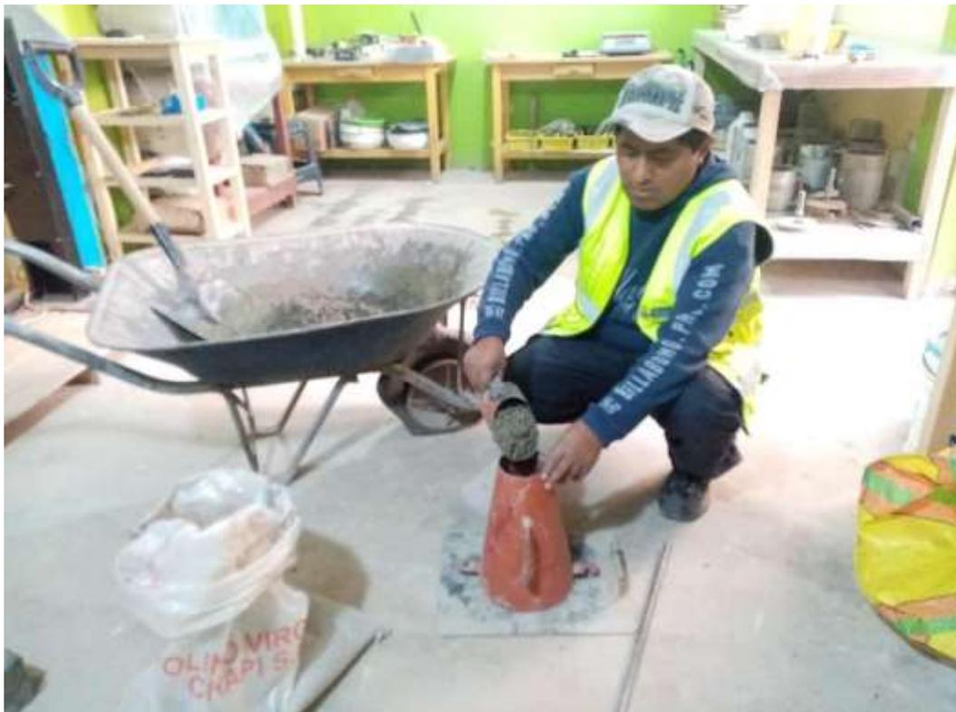
*Fotografía 6. Realizando en ensayo de slump.*
