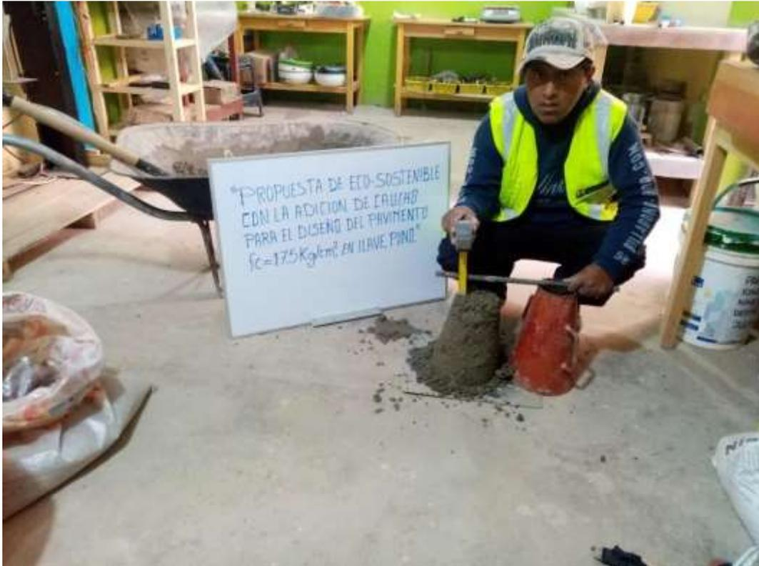
*Fotografía 7. Medición del slump*
