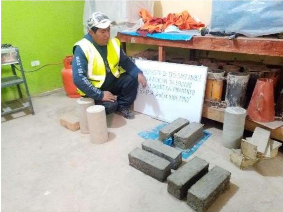
Fotografía 11. Ensayos de la resistencia a flexión del concreto – vigas.
