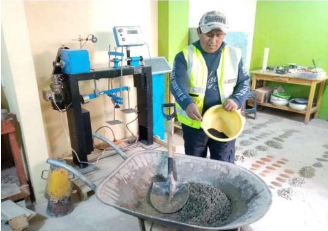
*Fotografía 5. Realizando el incremento del caucho a la mezcla patrón..*
