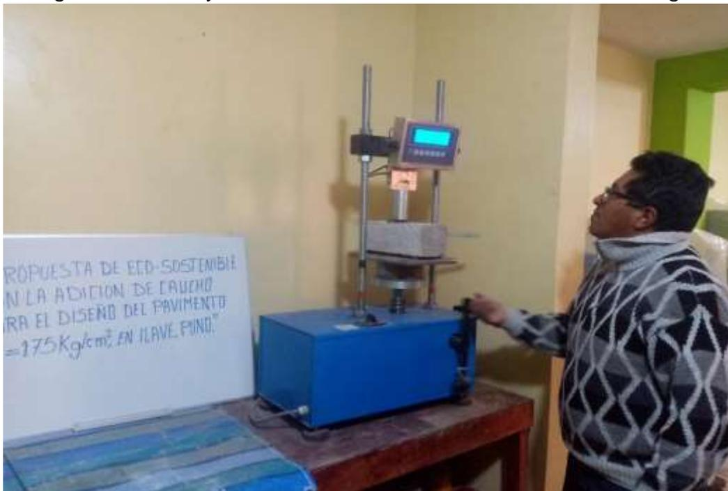
Fotografía 12. Realizando ensayos de la resistencia a flexión del concreto – vigas.
