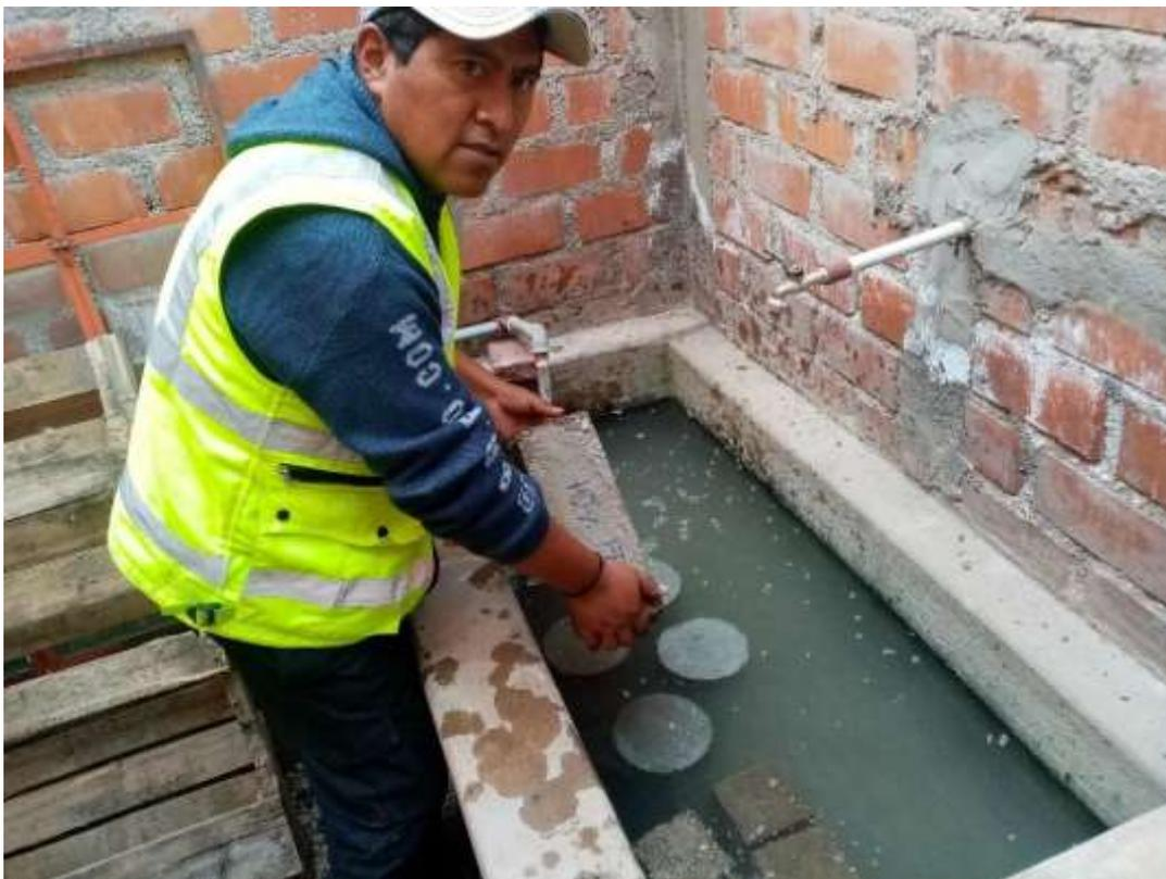
*Fotografía 8. Realizando el curado de las vigas y probetas.*
