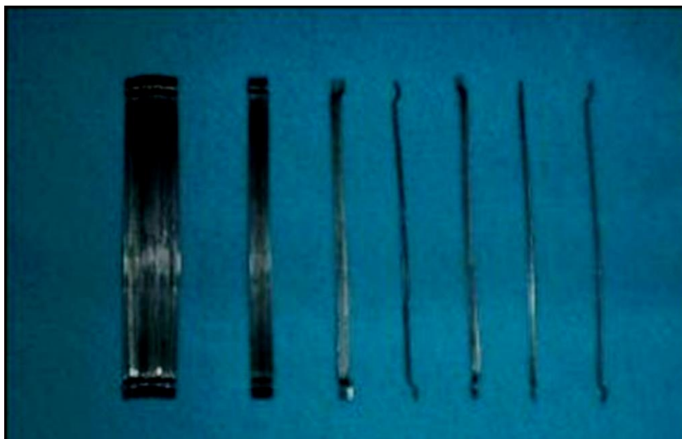
Figura 3. Fibras de acero deformadas en los extremos
