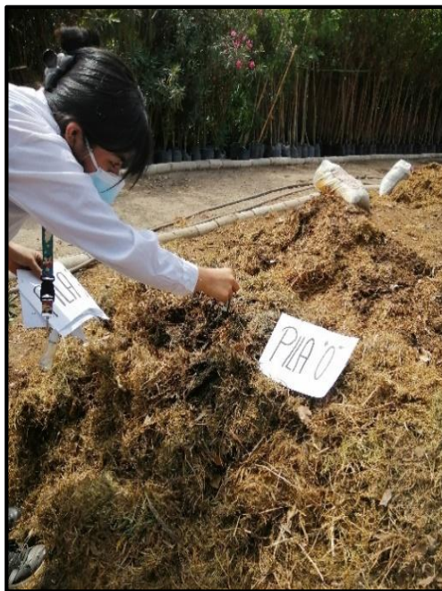
Medición de temperatura en la pila "0" de compostaje
