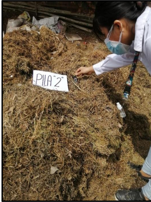
Medición de temperatura en la pila "2" de compostaje
