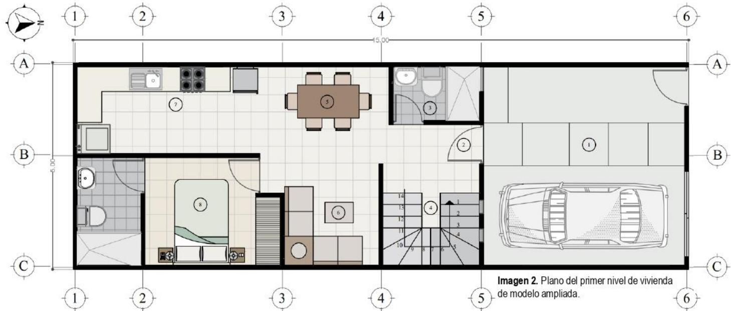
Imagen 2. Plano del primer nivel de vivienda de modelo ampliada.
