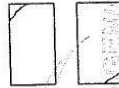
Tipo 5 Fracturas en los lados en las partes superior e inferior (ocurre comúnmente con cabezales no adheridos)
