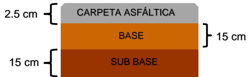
**Figura 31.** Espesores de Capas para el pavimento propuesto
