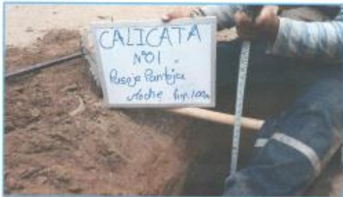
FOTO N°82 – Verificación de la profundidad de la Calicata C-01.
