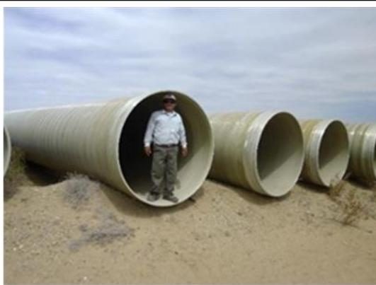
Foto N° 26.- Tubería GRP.
