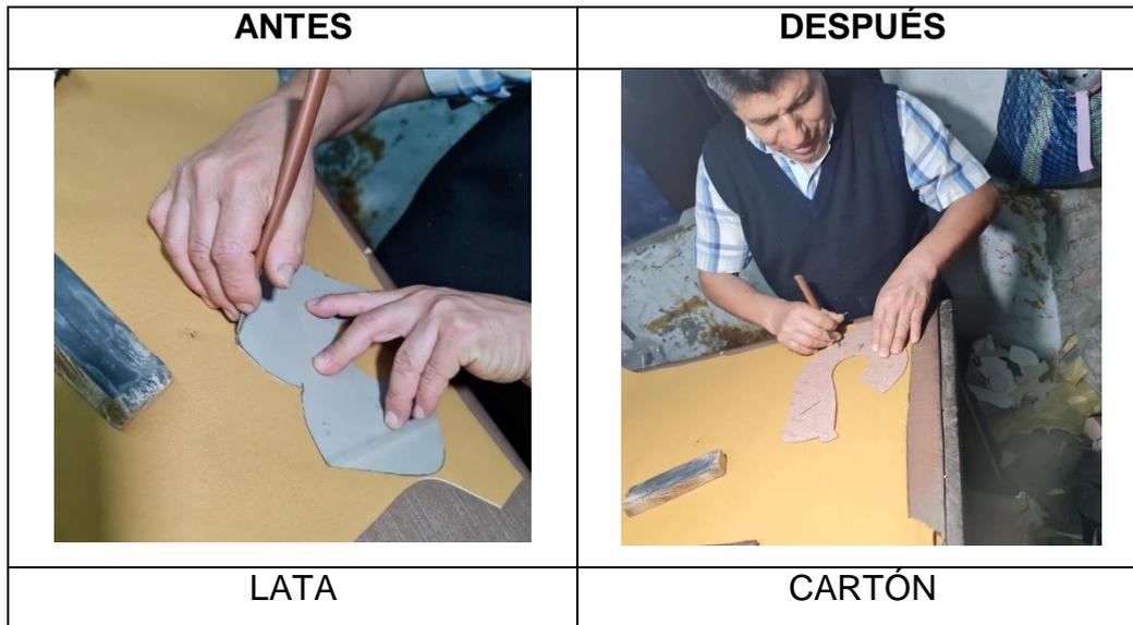
**Figura 16.** Implementación del Poka Yoke en el área de corte.
