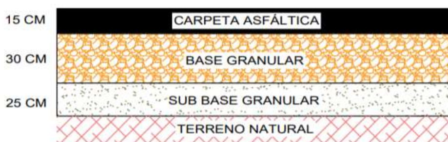
Figura 45. Espesores del pavimento de la Prolongación Francisco de Zela
