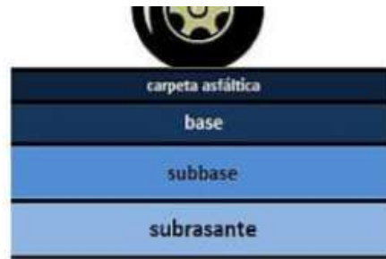
Figura 1. Sección transversal del pavimento flexible
