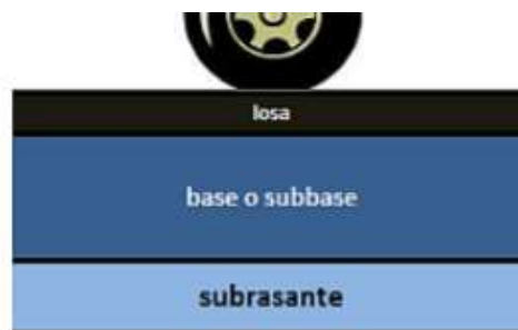
Figura 3. Sección transversal del pavimento rígido
