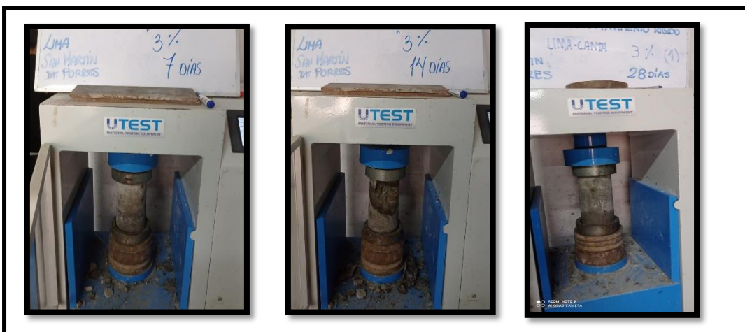
Figura 51. Concreto con 3% de CT sometido a compresión a los 7, 14 y 28 días
