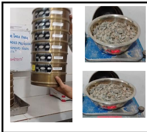
Figura 17. Una vez colocada la grava dentro de los tamices se tapa la superficie y se agitan los tamices para que los materiales puedan pasar y tener una mejor distribución.
