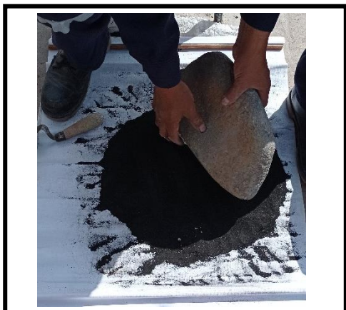
Figura 5. Se muele la Ceniza de Tara como proceso final
