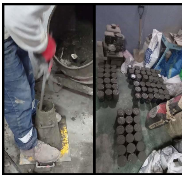
Figura 19. Llenado de mezcla en 3 capas, chuceo con varilla 25 golpes por c/capa y llenado de testigos.
