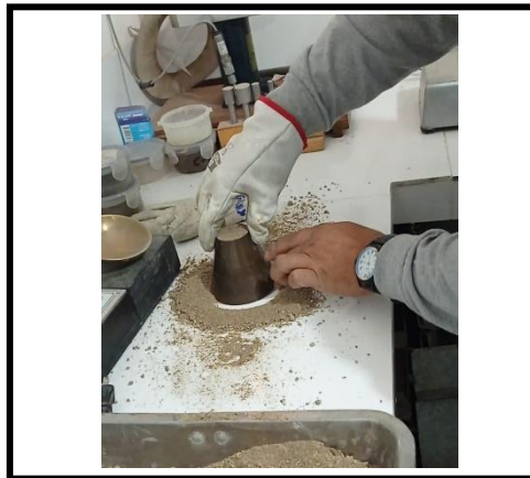
Figura 33. Se limpia el material suelto alrededor de la base del cono.
