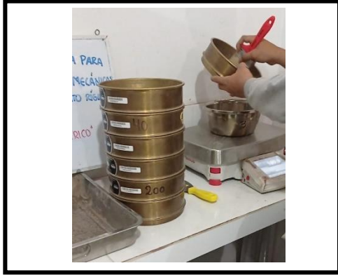
Figura 13. Con ayuda de una brocha retiramos las partículas que quedan en las rendijas del tamiz y se tare completamente las proporciones, se realiza para todos los tamices por igual.
