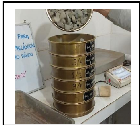
Figura 16. Adición de grava a los tamices para su distribución por tamiz
