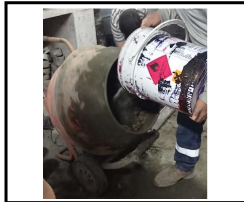
Figura 40. Mezcla de materiales para realizar las pruebas SLUMP con las dosificaciones
