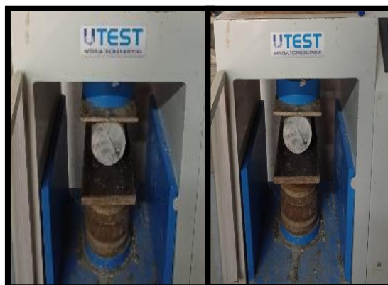
Figura 25. Colocación de probetas en la prensa hidráulica por el lado diametral para ser sometidas a tracción indirecta
