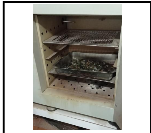
Figura 30. Finalmente se lleva al horno por 24 horas y determinar de este modo su contenido de humedad
