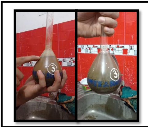
Figura 21. Luego de ello se le añade agua hasta el nivel señalado para saturar la muestra y luego se agita para eliminar las burbujas de aire que se forman.
