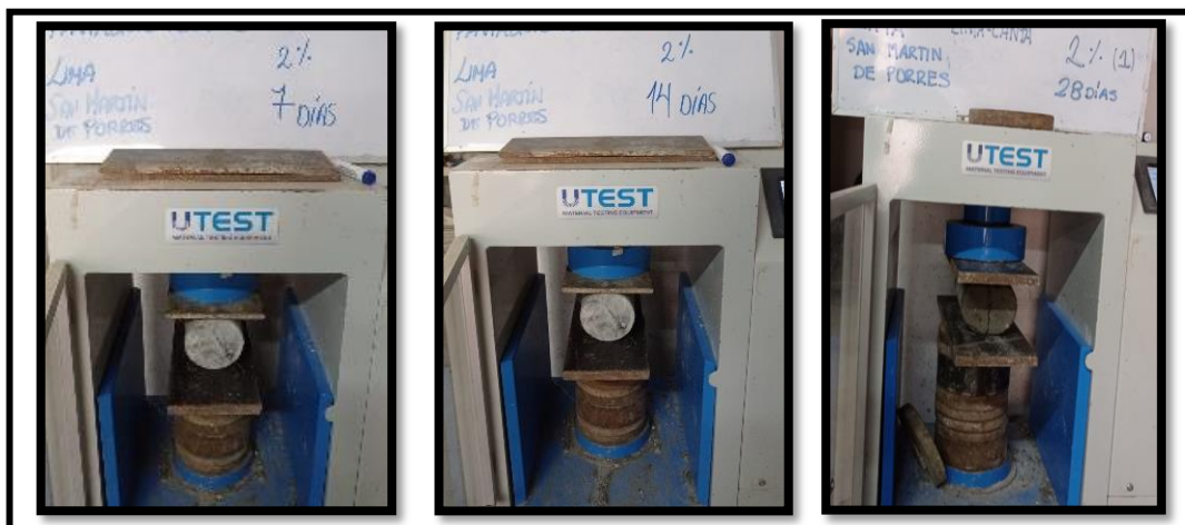
Figura 55. Concreto con 2% de CT sometido a compresión a los 7, 14 y 28 días
