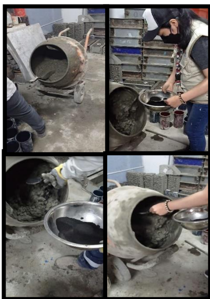
Figura 18. Adición de proporciones de ceniza de Tara (0%, 1%, 2%, 3%) a la mezcla de concreto.
