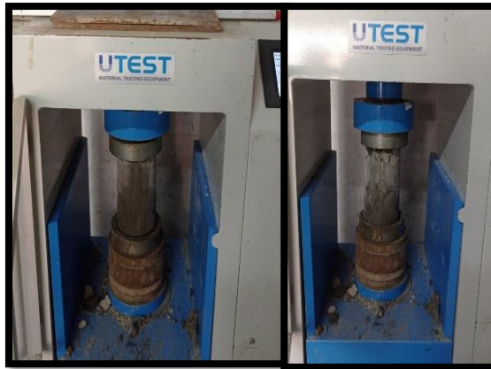
Figura 22. Colocación de probetas en la prensa hidráulica para ser sometidas a compresión
