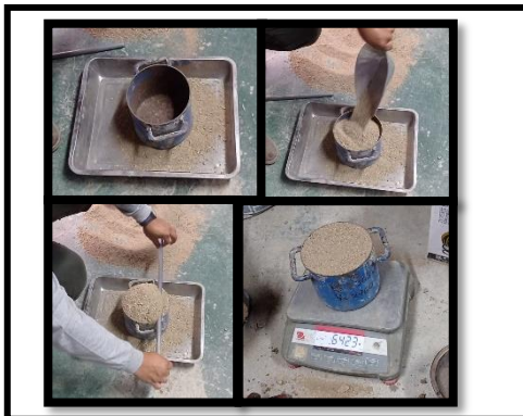
Figura 35. Sin compactar: Se llena el recipiente, luego se enraza con la varilla lisa de 5/8", luego de enrazar se limpia los bordes y se pesa.
