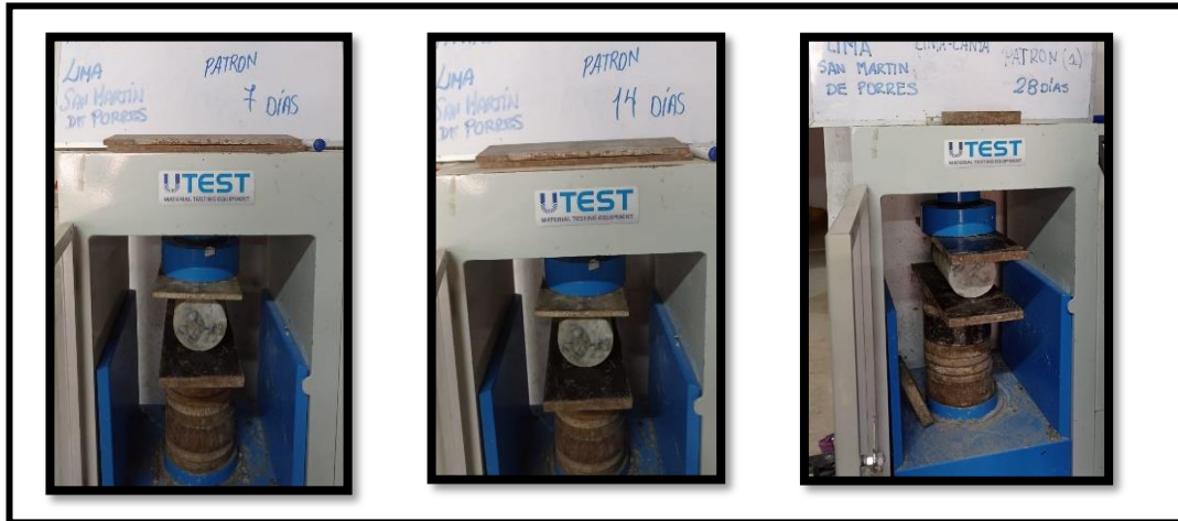
Figura 53. Concreto patrón sometido a tracción indirecta a los 7, 14 y 28 días
