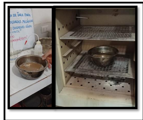
Figura 24. Una vez que se tiene en el recipiente el material se pasa al horno por 24 horas, de este modo se obtiene el contenido de humedad.
