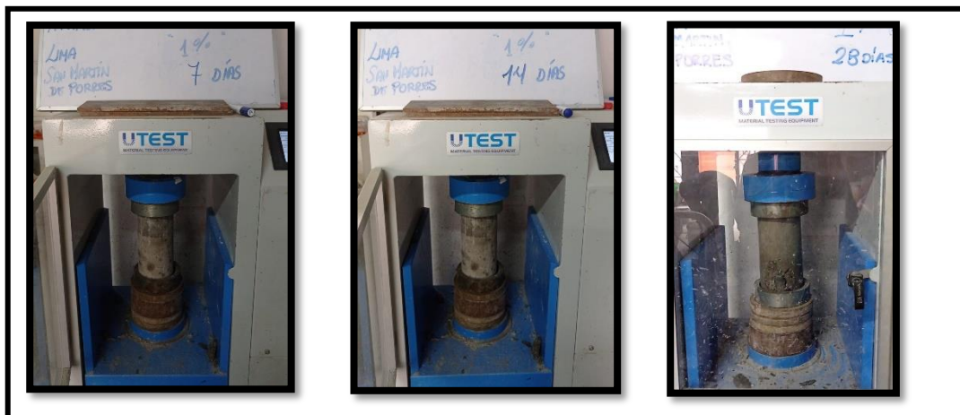
Figura 49. Concreto con 1% de CT sometido a compresión a los 7, 14 y 28 días
