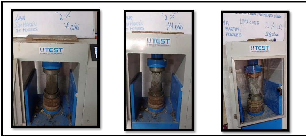
Figura 50. Concreto con 2% de CT sometido a compresión a los 7, 14 y 28 días
