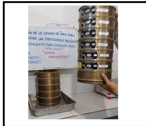
Figura 11. Una vez colocada la arena dentro de los tamices se tapa la superficie y se agitan los tamices para que los materiales puedan pasar y tener una mejor distribución.
