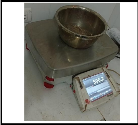
Figura 19. Se extrae un kilo de arena como muestra, del cual se utiliza 500 gr para el peso específico como se percibe ahora, mientras que lo restante será para determinar la absorción
