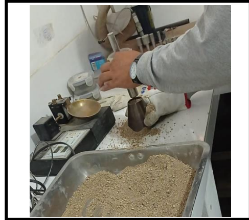
Figura 32. Se realiza la prueba de pisón con 10 golpes, luego se añade 3 cantidades de arenas y continúan con 10, 3 y 2 golpes respectivamente.
