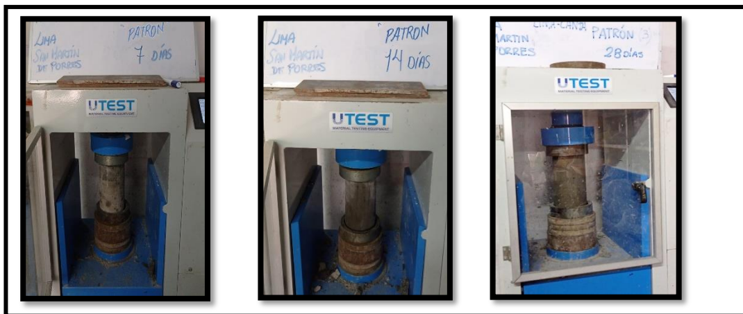
Figura 48. Concreto patrón sometido a compresión a los 7, 14 y 28 días
