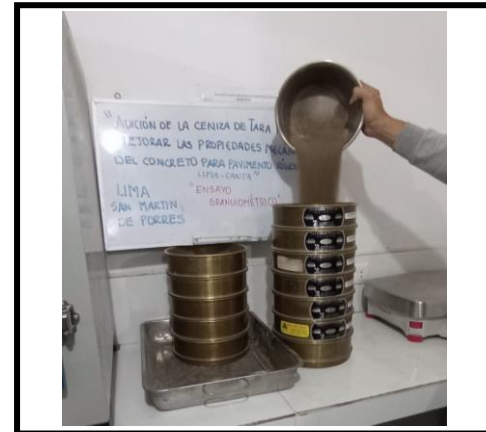
Figura 10. Adición de arena a los tamices para su distribución por tamiz
