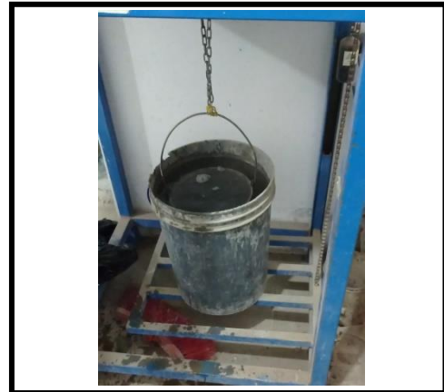
Figura 28. Luego se sumerge en agua para pesarlo; a través de esa cadena va sujeto a una balanza donde debe dar una cantidad aproximada de 2500gr. o 2½ k.
