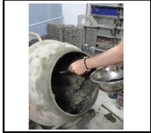
Figura 44. Adición de ceniza de Tara 3% a la mezcla de concreto.
