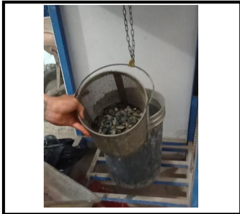
Figura 27. Luego se coloca en la canastilla para densidad y peso específico
