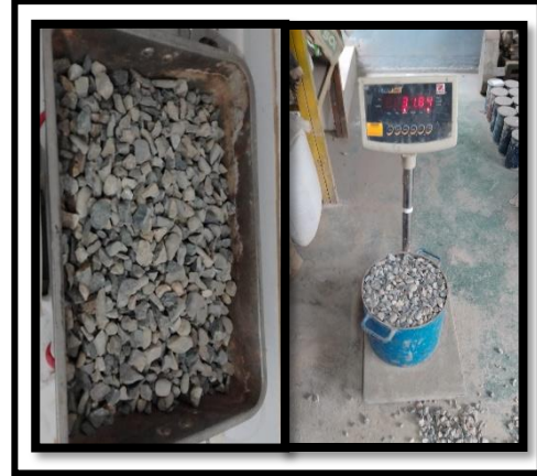
Figura 38. Compactado: Se llena el material en 3 capas, se chucea c/capa con 25 golpes y con el maso de goma golpes a los lados por capa de 10 a 15 golpes. Luego se enraza, se limpia los lados y se pesa.
