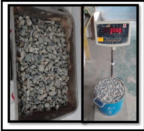
Figura 37. Previamente el AG fue secada en el horno. Sin compactar se llena el recipiente con AG hasta el tope, luego se enraza con la varilla lisa de 5/8" y se pesa.
