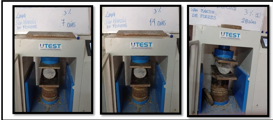
Figura 56. Concreto con 3% de CT sometido a compresión a los 7, 14 y 28 días
