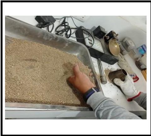
Figura 31. El agregado fino debe tener al menos 1% de humedad por 24 horas. Para empezar, se rellena el cono de arena.
