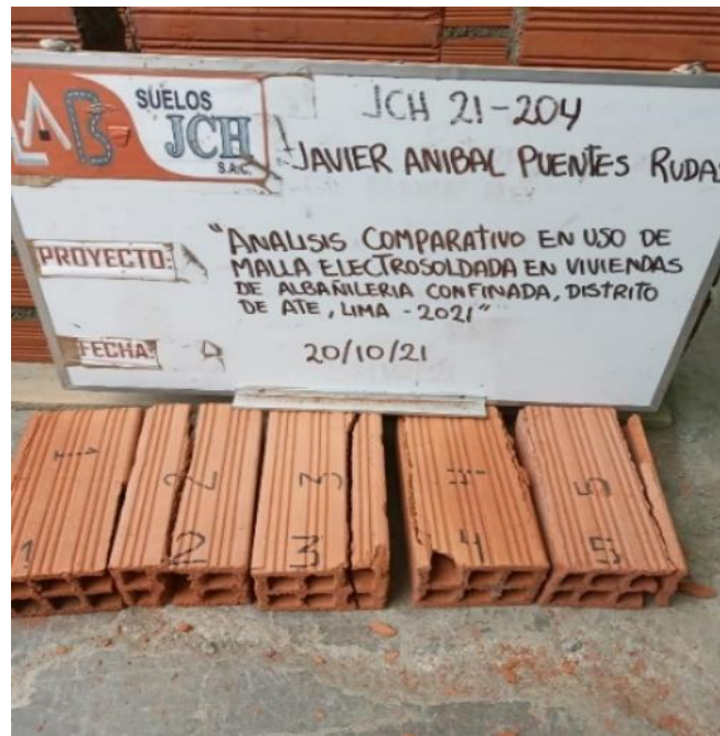
Figura 31. Ladrillos rotos después del ensayo Fuente: imagen propia
