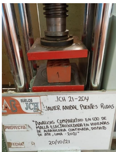
Figura 29. Ensayo a la unidad kk Fuente: imagen propia
