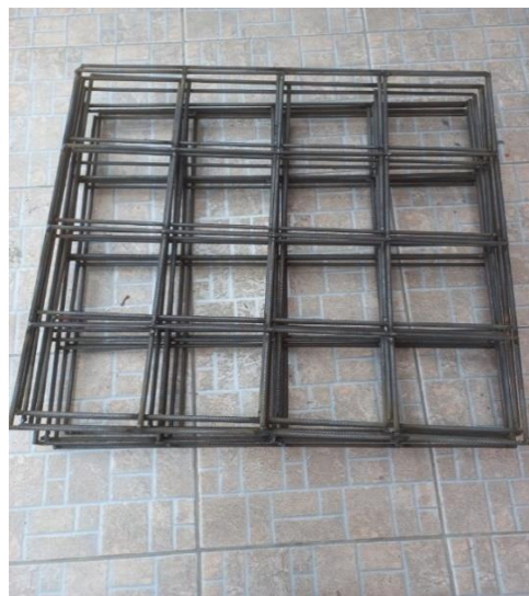
Figura 2. Malla electrosoldada preparada para los muretes
