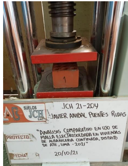
Figura 22. Ensayo a compresión a la unidad Fuente: propia
