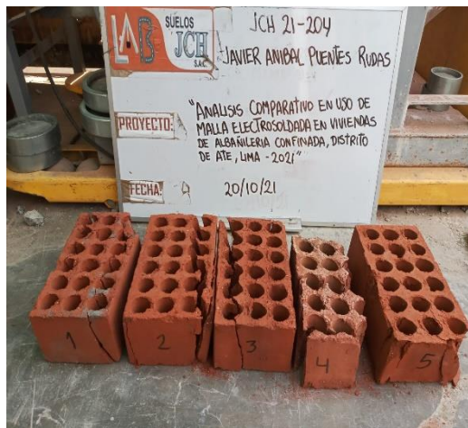
Figura 30. Ladrillos rotos después del ensayo Fuente: imagen propia
