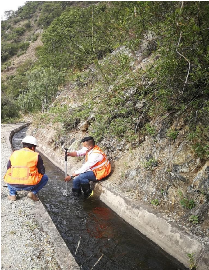
Fotografía 5. Medición con correntómetro
