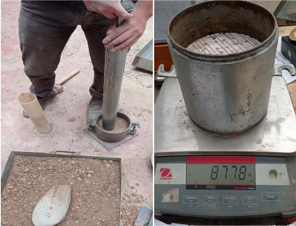
figura 16.elaboración de ensayo de CBR y pesaje de molde con material compactado
