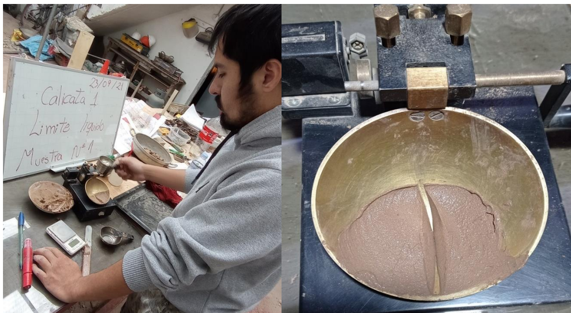
figura 8.ensayo de limite plástico con la utilización de la cuchara de casa grande
