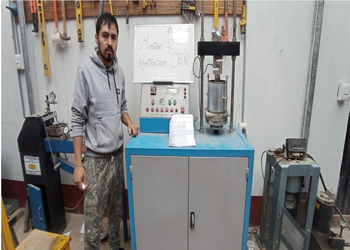
FOTO 7: ensayo de perneracion CBR
