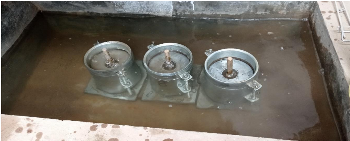
FOTO 6: prueba de expansión mondel de CBR
