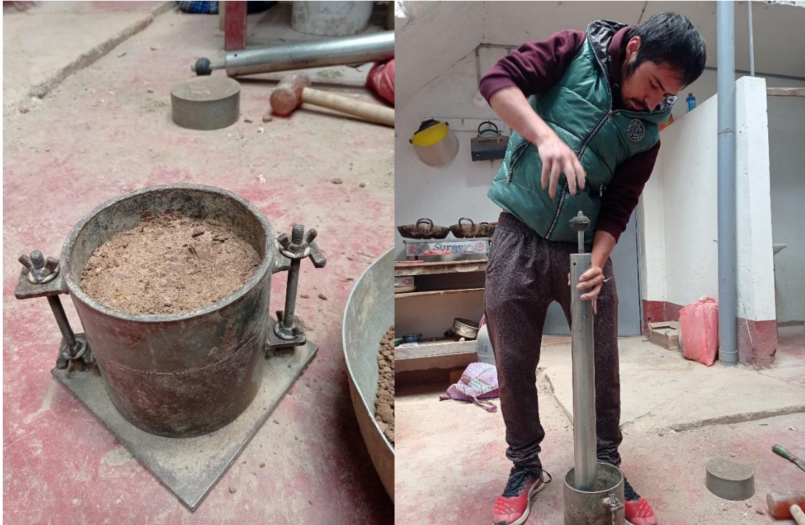
figura 10.compactación de la muestra en molde de Proctor
