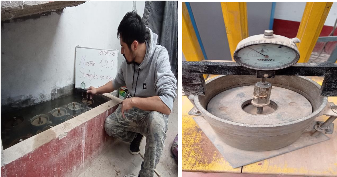
figura 14.lectura de expansión antes y después de sumergir muestra
