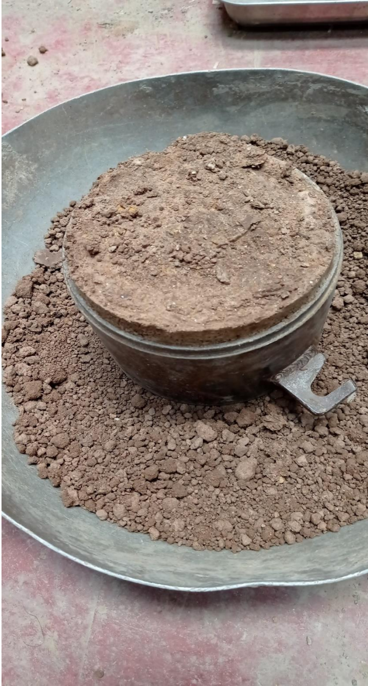
FOTO 5: desmolde de prueba de proctor
