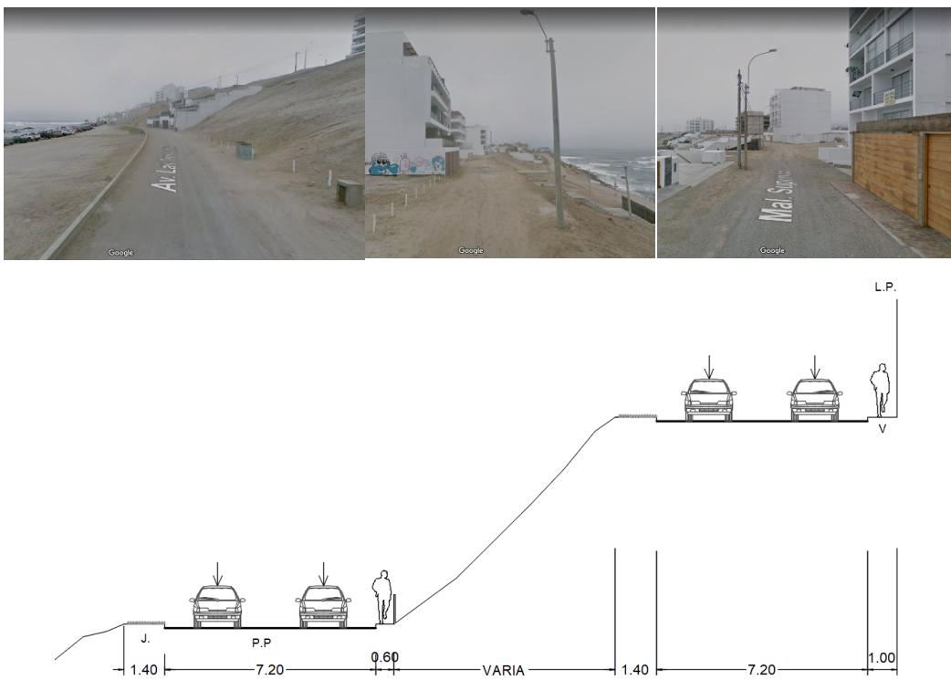
Figura 31. Malecón. Fotografía y corte de vía actual – Vía Malecón
