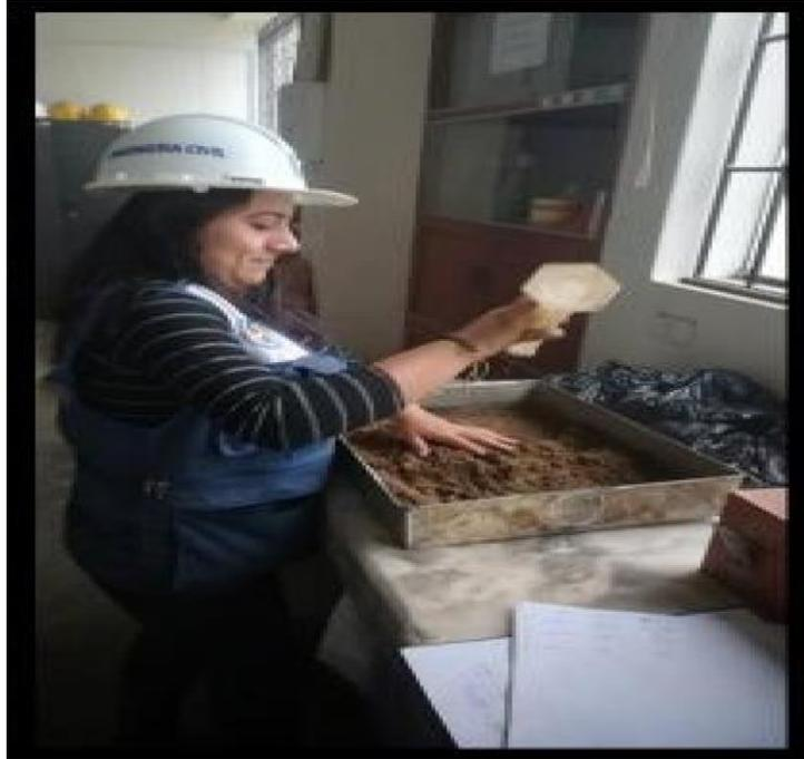
FIGURA 13: Añadiendo el agua a la muestra experimental para realizar el CBR.
