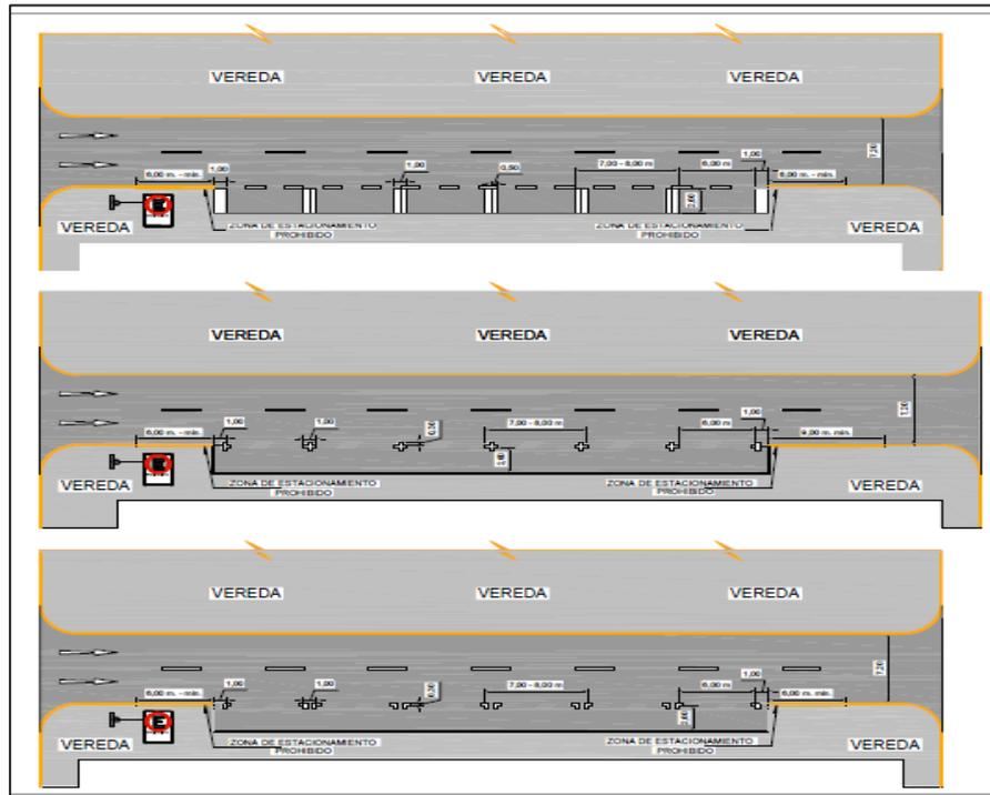
*Ilustración 36* Demarcación con dimensiones en espacios para estacionamiento de vehículos
