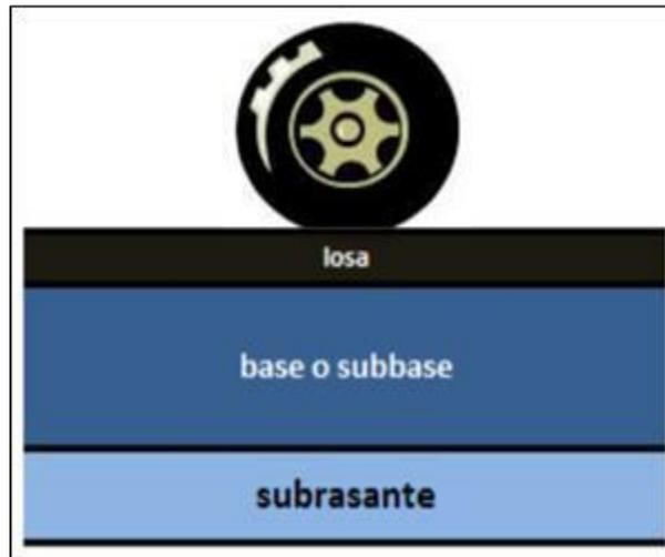
*Ilustración 8* Esquema de componentes de un pavimento rígido.
