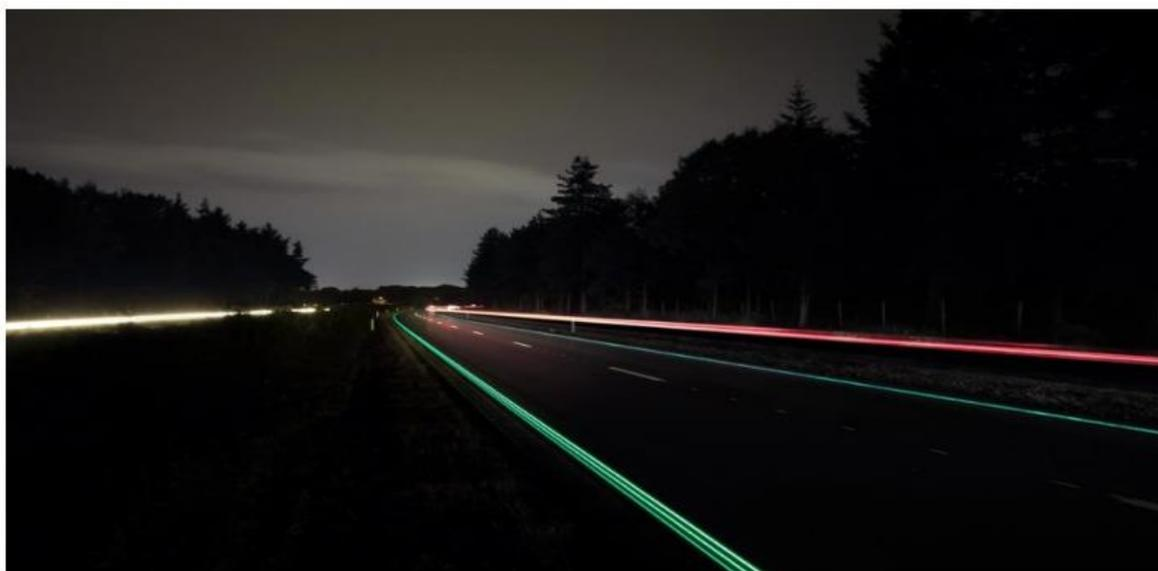
**Ilustración 65** Pintura con efecto fluorescente por la absorción de rayos ultravioleta solares y emisión de un verde neón en la noche
