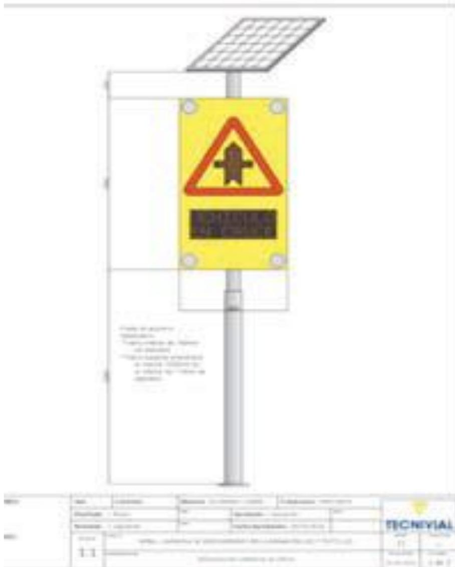
**Ilustración 64** Diseño de señal luminosa con iluminación led y texto, con dimensiones
