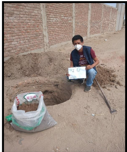
Fotografía N° 4. Obtención de muestra a través de calicata (Ferreñafe).
