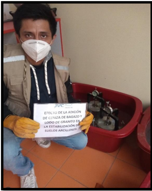
Fotografía N° 13. Probetas de CBR sumergidas en poza.
