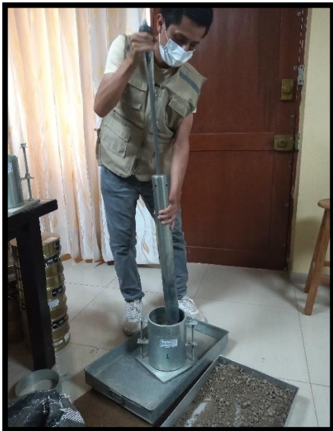
Fotografía N° 11. Compactación de muestra con pisón.
