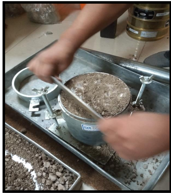
Fotografía N° 10. Enrasado de ultima capa-Ensayo Proctor modificado.
