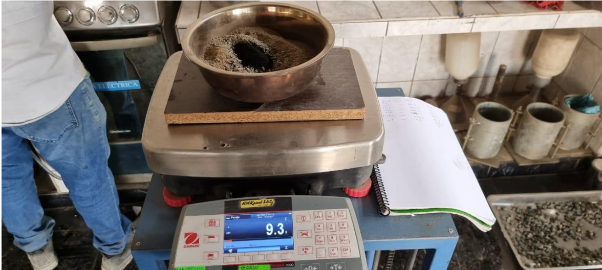
combinación de los agregados según el peso
