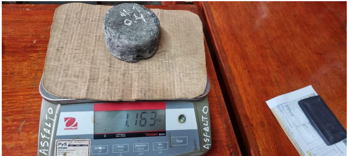
pesado de las briquetas después del ensayo cántabro
