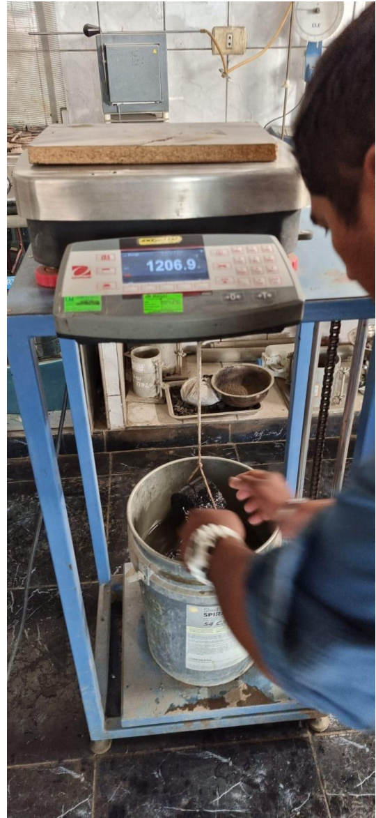
determinación del peso específico de las briquetas
