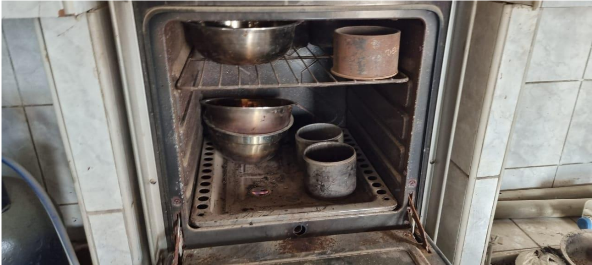
molde de briquetas y agregados en horno
