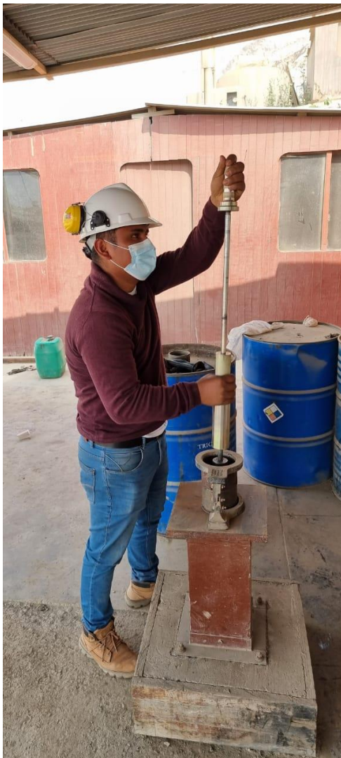
Compactación manual de las briquetas con el martillo Marshall a 75 golpes por lado
