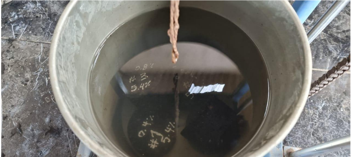
sumergido de briquetas en agua a 25°C por 5 minutos
