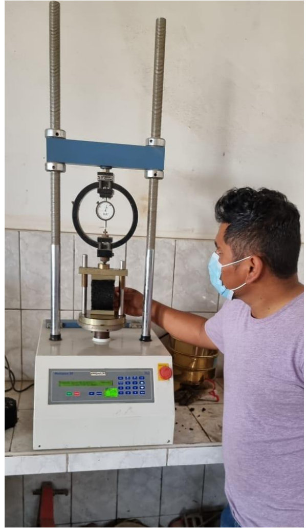
Ensayo de traccion indirecta
