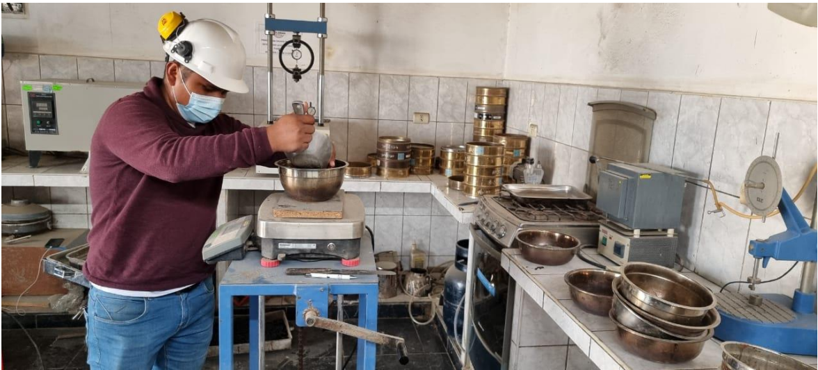
pesado de los agregados según la cantidad del diseño incorporación de cemento asfáltico según el diseño patrón
