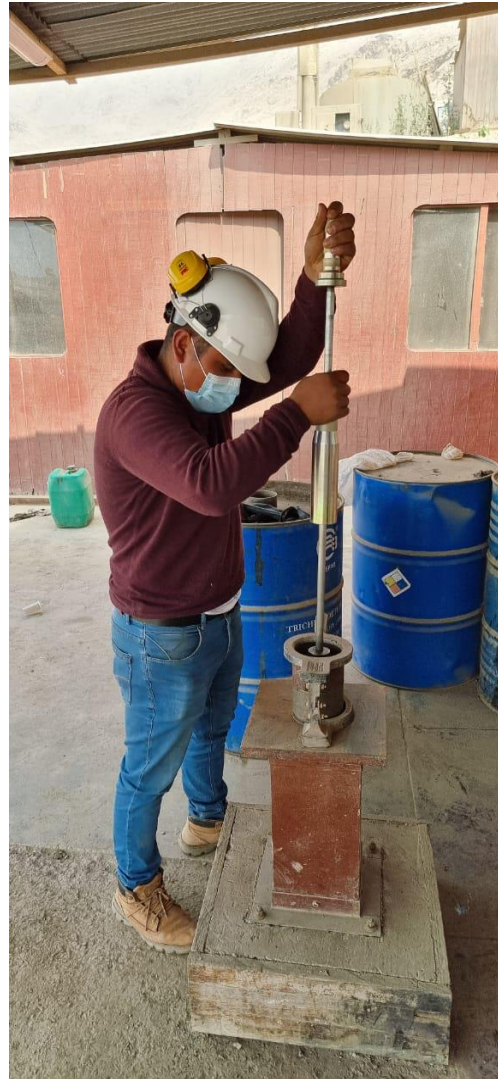
Compactación manual de las briquetas con el martillo Marshall a 75 golpes por lado
