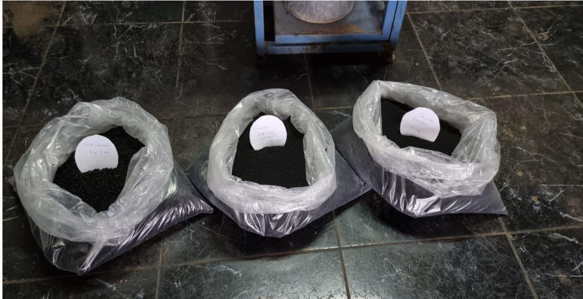
Caucho reciclado obtenido mediante el triturado mecánico (proveedor Nort Soul S.R.L)
