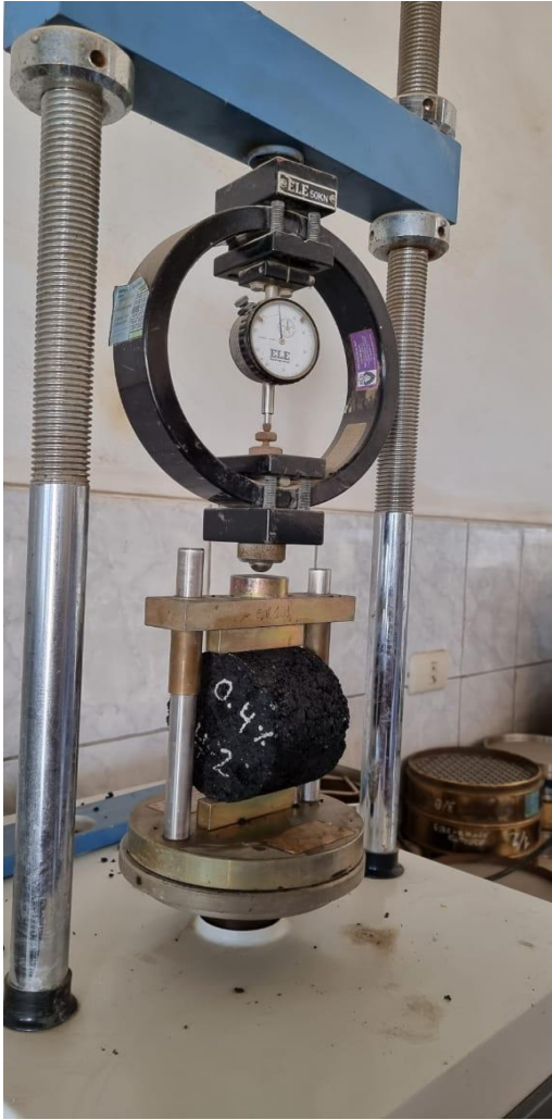
Ensayo de traccion indirecta
