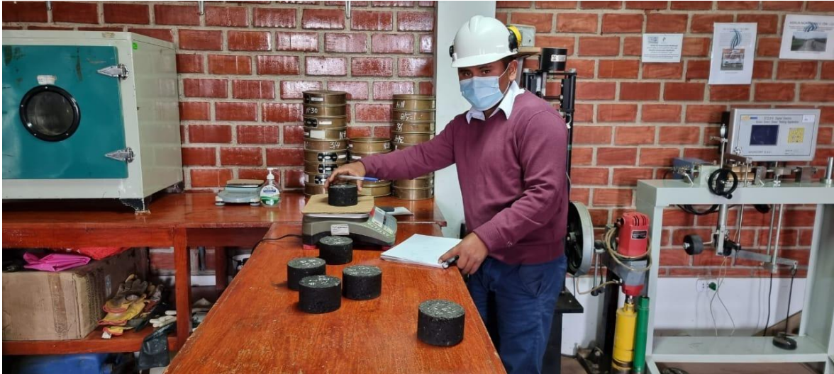
Pesado de las briquetas para el ensayo cántabro
