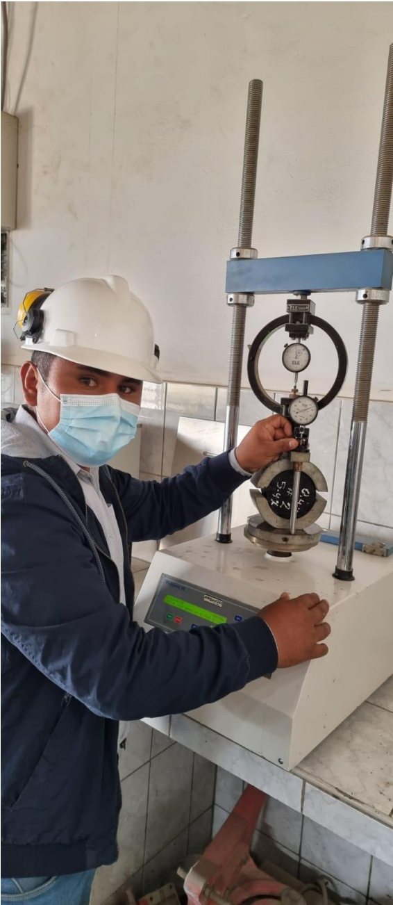
ensayo de las briquetas en el equipo Marshall
