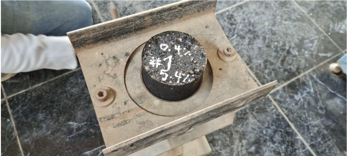
extracción de las briquetas con un extractor de núcleos
