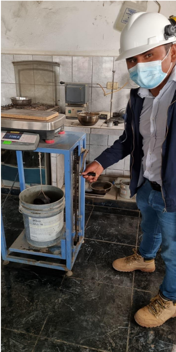
determinación del peso específico de las briquetas
