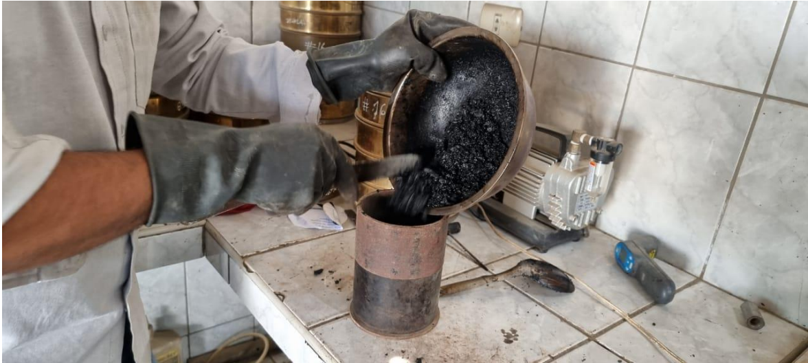
molde de la mezcla asfáltica en caliente
