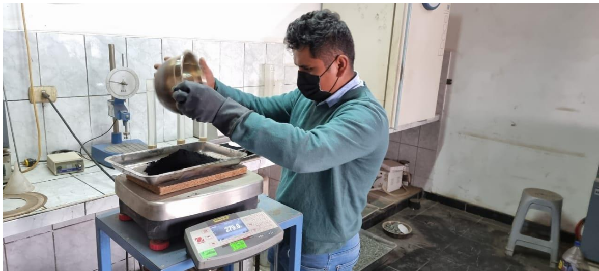
Pesado de caucho para el análisis granulométrico
