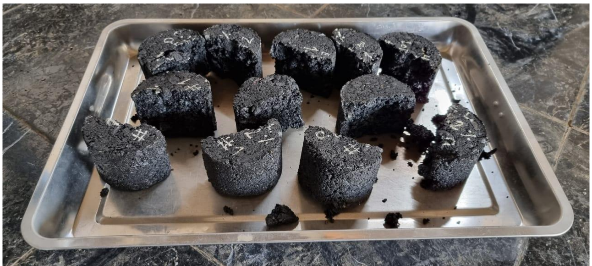
Briquetas después del ensayo de compresión diametral
