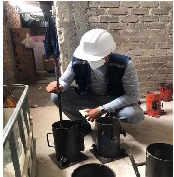
**Figura 15 y 16:** En las imágenes podemos observar al personal realizando el moldeo de los testigos de concreto.
