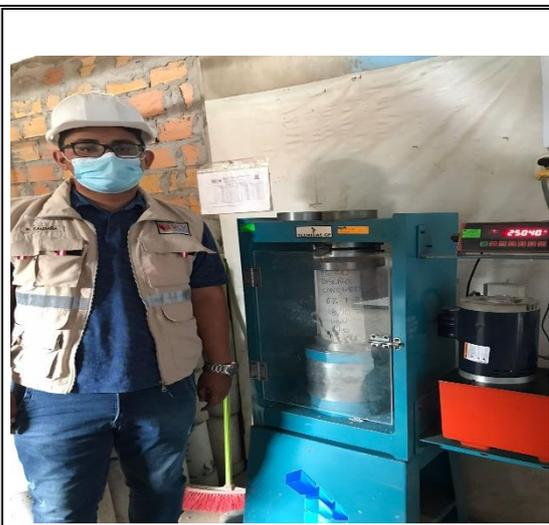
**Figura 19 y 20:** En las imágenes podemos observar al personal presentando la rotura de probetas, a la resistencia a la compresión axial de los testigos de concreto.
