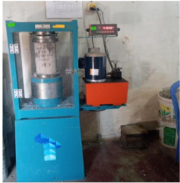
**Figura 17 y 18:** En las imágenes podemos observar la resistencia a la compresión axial de los testigos de concreto.
