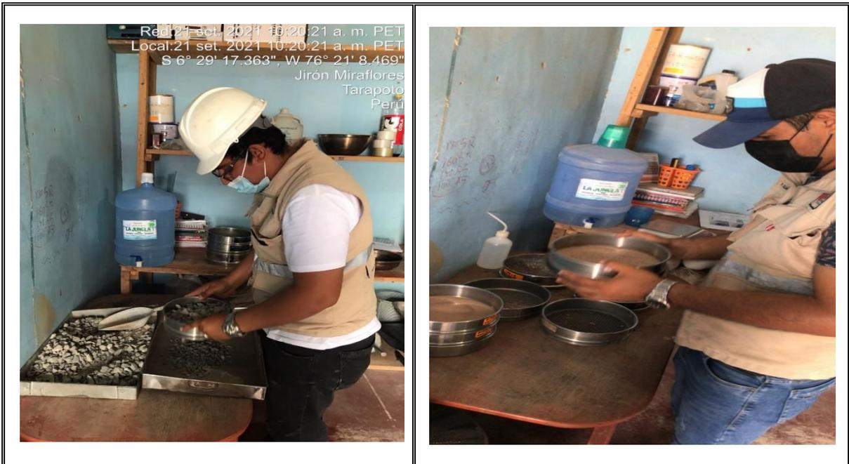
**Figura 1 y 2:** En las imágenes se puede apreciar el ensayo de análisis granulométricos.
