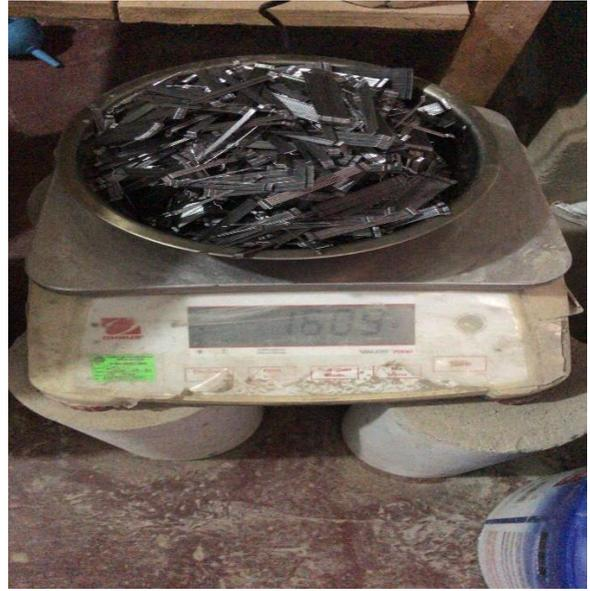
**Figura 9 y 10:** En las imágenes podemos apreciar los materiales a utilizar para el diseño de concreto con adición de fibras de acero.
