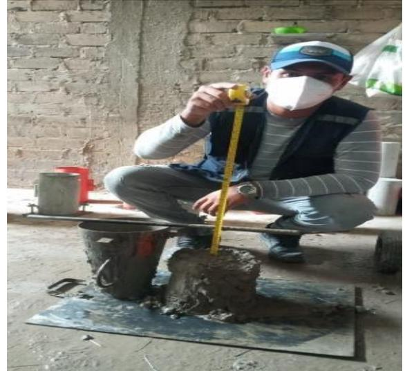
**Figura 13 y 14:** En las imágenes podemos observar al personal realizando la prueba de asentamiento para los diseños de Mezclas.
