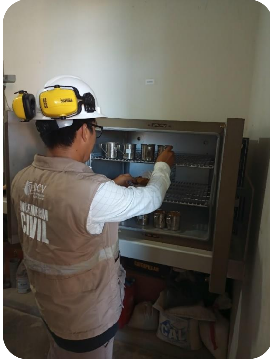
Vista fotográfica N°10: Se observa al tesista sacando las muestras del horno, para realizar los demás ensayos, como granulometría, límite líquido y plástico.
