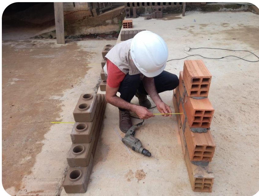
Vista fotográfica N°23: Se observa la aplicación de los termómetros en cada uno de los tipos de ladrillos.
