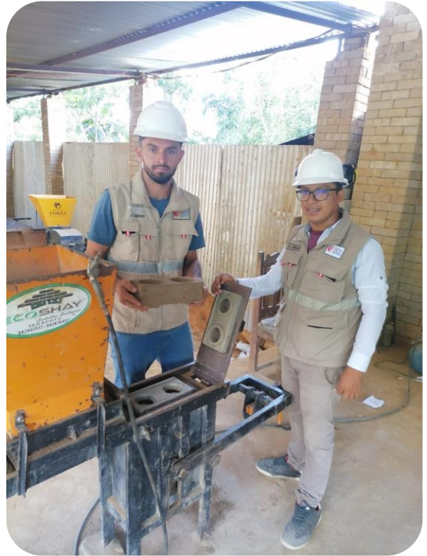
Vista fotográfica N°14 y 15: Se observa a los tesistas, realizando los ladrillos ecológicos en la máquina de molde.
