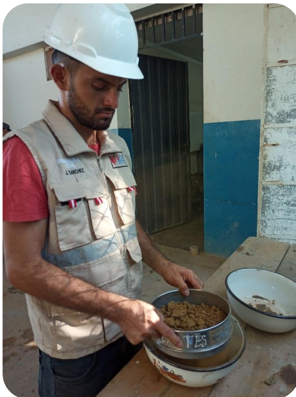
Vista fotográfica N°07: Se observa al tesista desarrollando el ensayo de granulometría de la arcilla (ligante).
