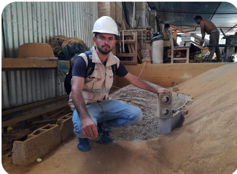
Vista fotográfica N°05: Se observa el material de la arena con la cual se trabajó para el proceso de mezcla del ladrillo ecológico.
