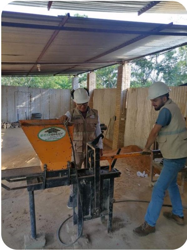
Vista fotográfica N°14 y 15: Se observa a los tesistas, realizando los ladrillos ecológicos en la máquina de molde.
