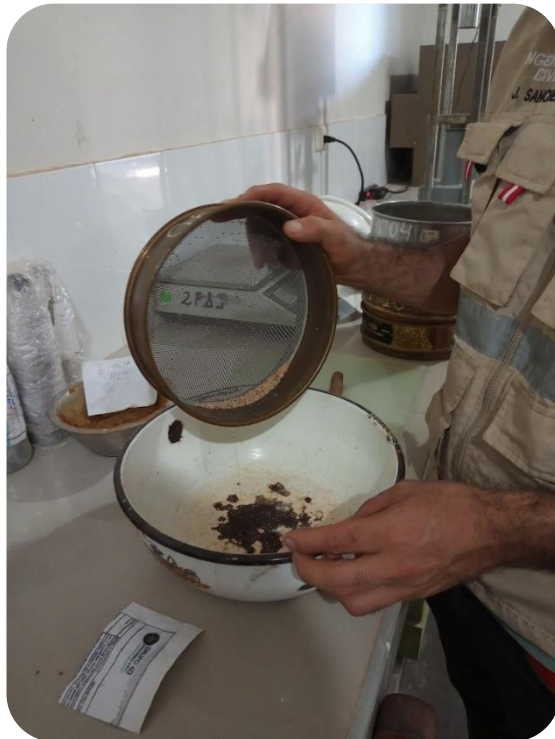
Vista fotográfica N°11: Se observa al tesista realizando el ensayo de la granulometría de la arena.
