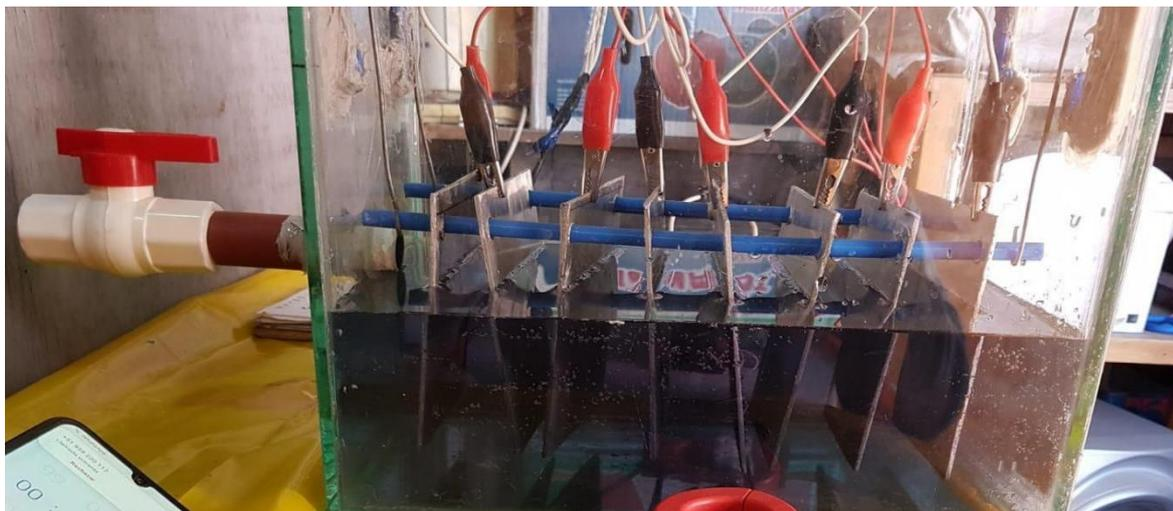
Figura N° 43: Celda con agua residual de curtiembre antes de ser tratada
