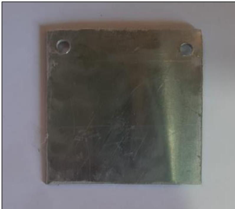
Figura N° 18: Placa de aluminio de 12 cm x 12 cm x 3 mm
