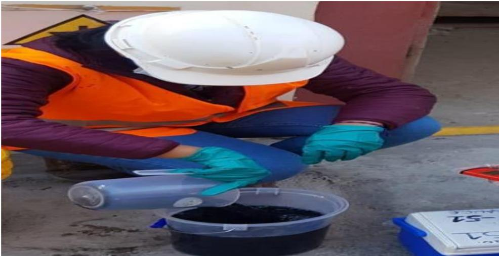
Figura N° 42: Recolección de aguas residuales de curtiembre para realizar las pruebas del tratamiento de electrocoagulación.
