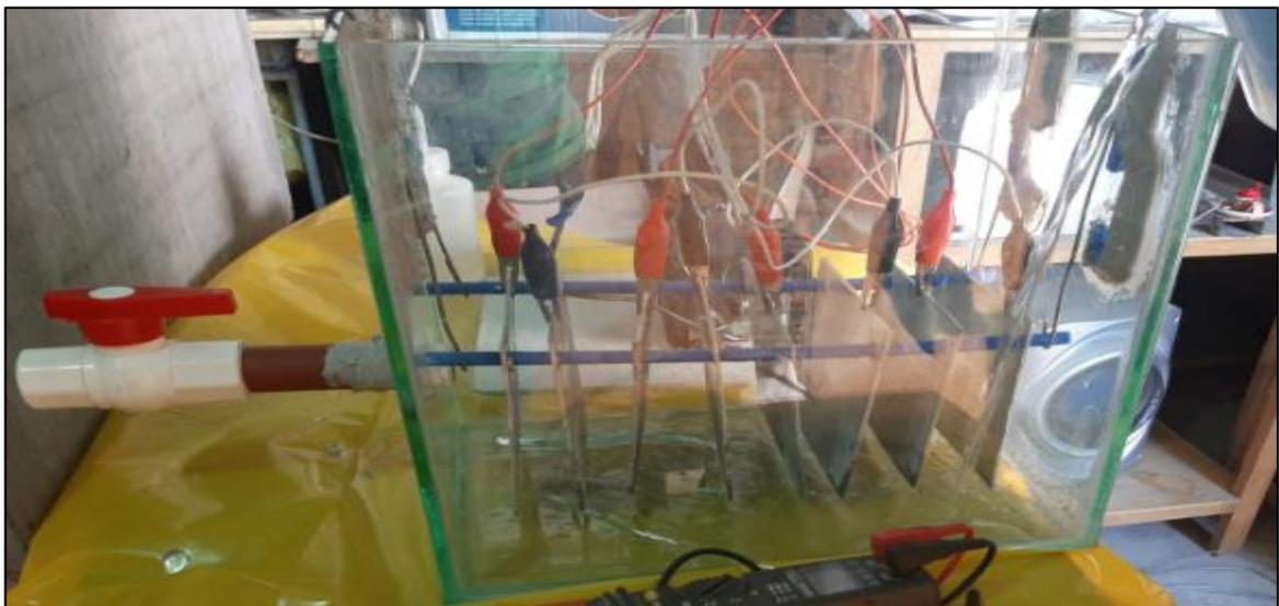
Figura N° 34: Conexión de pinzas tipo de cocodrilo.
