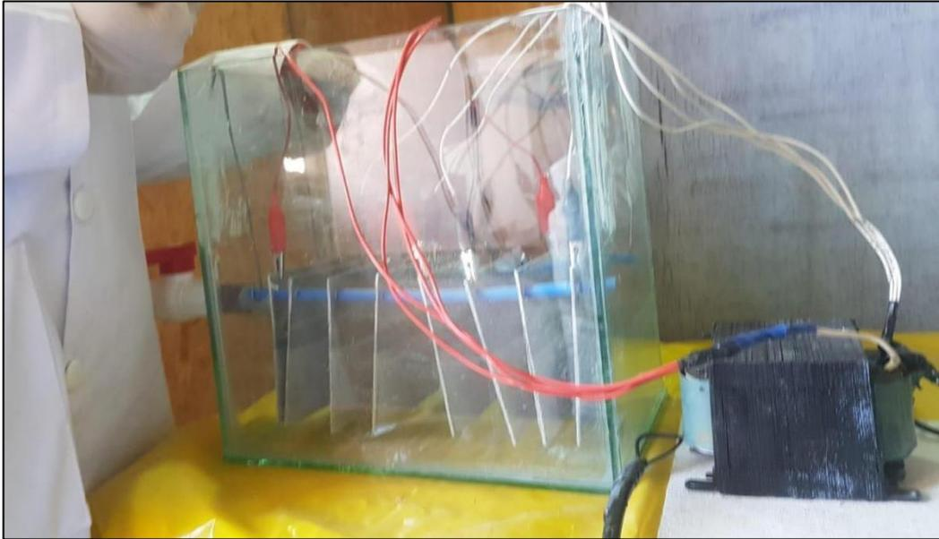
Figura N° 35: Conexión de pinza tipo cocodrilo a la fuente de alimentación eléctrica.
