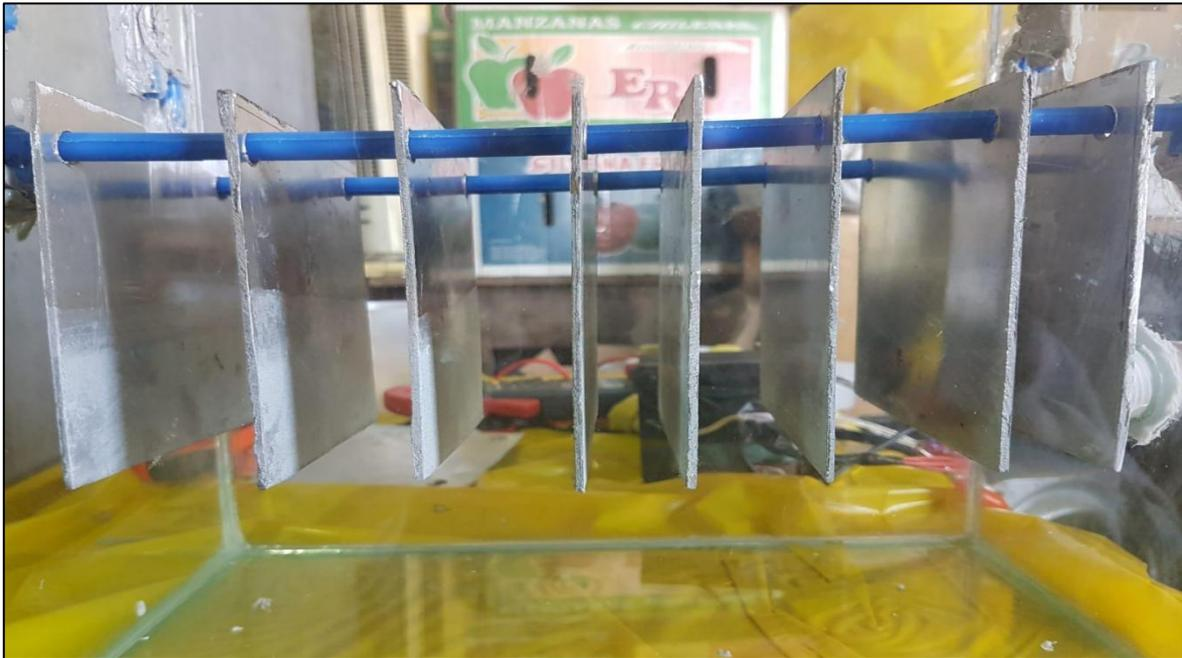
Figura N° 31: Colocación de placas con una separación de 4 cm.
