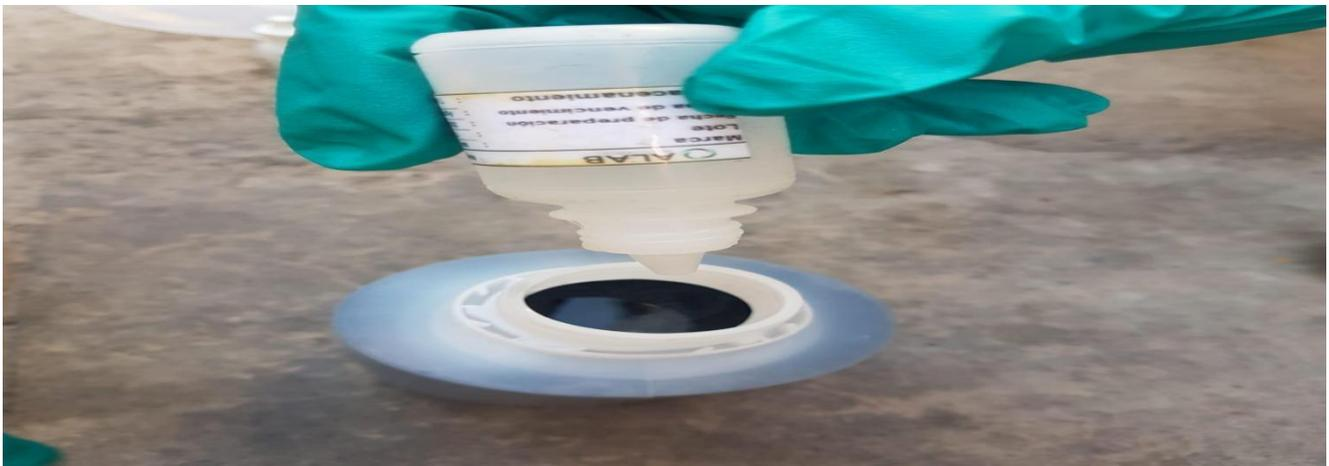
Figura N° 40: Inoculación de preservantes muestra ARCU1 (muestra 1)
