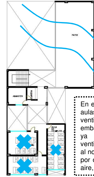
FUENTE: PROPIA - 4 PISO VENTILACIÓN NATURAL - CRUZADA
