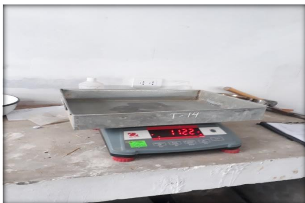
FIGURA N°16 - Pesado y distribución de terreno natural.
