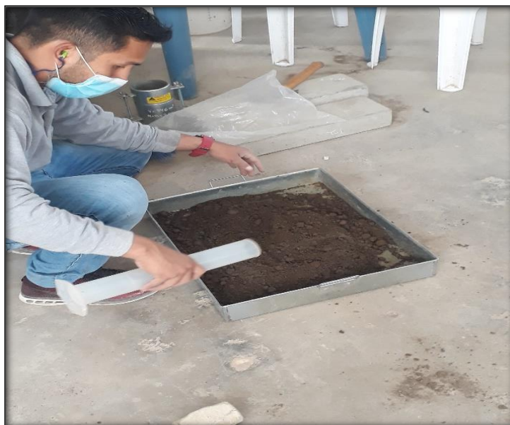
FIGURA N°18 - Aplicación de los porcentajes de resina de poliuretano.
