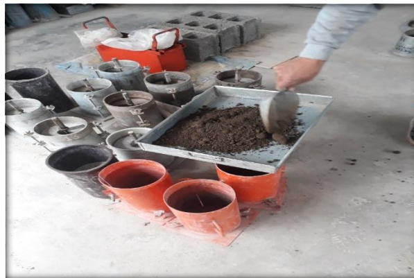
FIGURA N°16 - Pesado y distribución de terreno natural.
