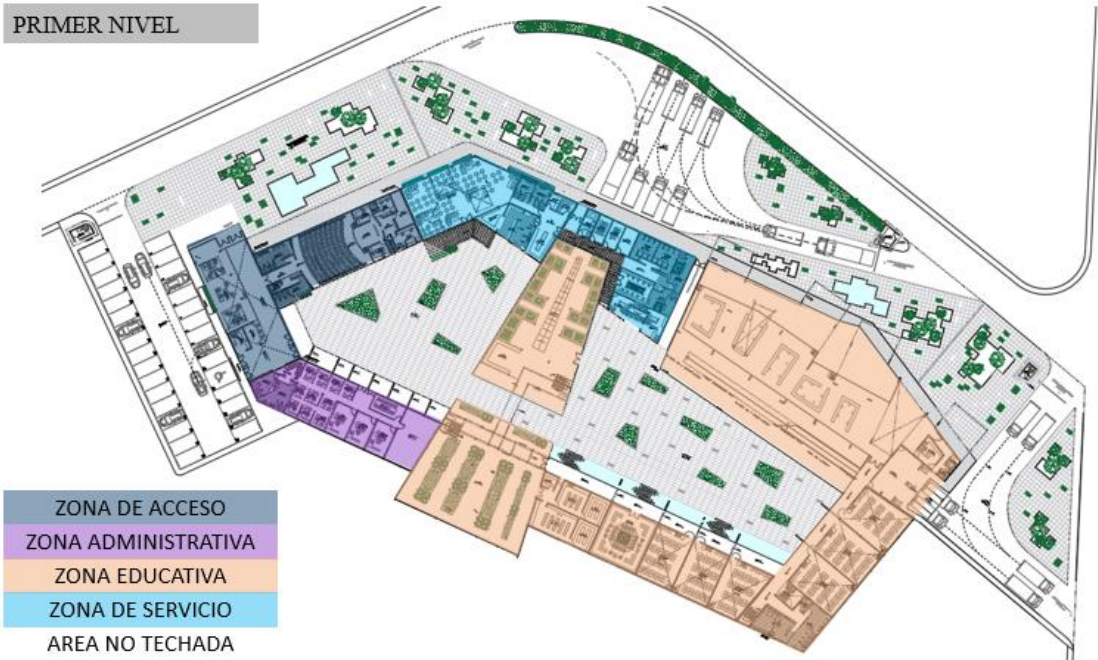
Figura 71. Zonificación de primer nivel.
