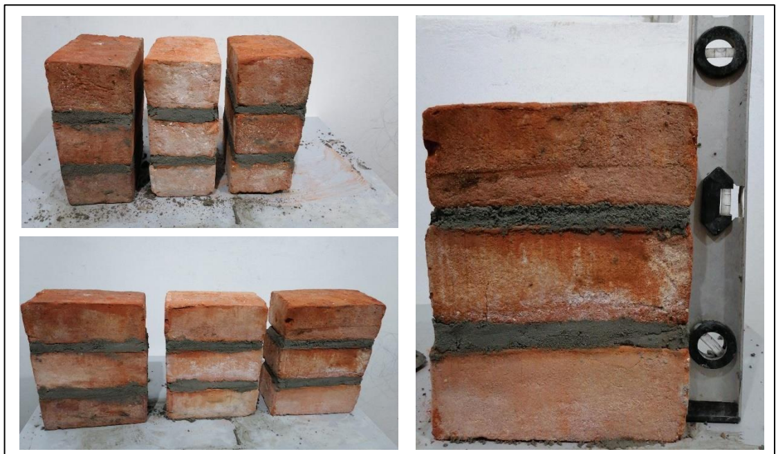
Figura 37. Elaboración de pilas de ladrillo
