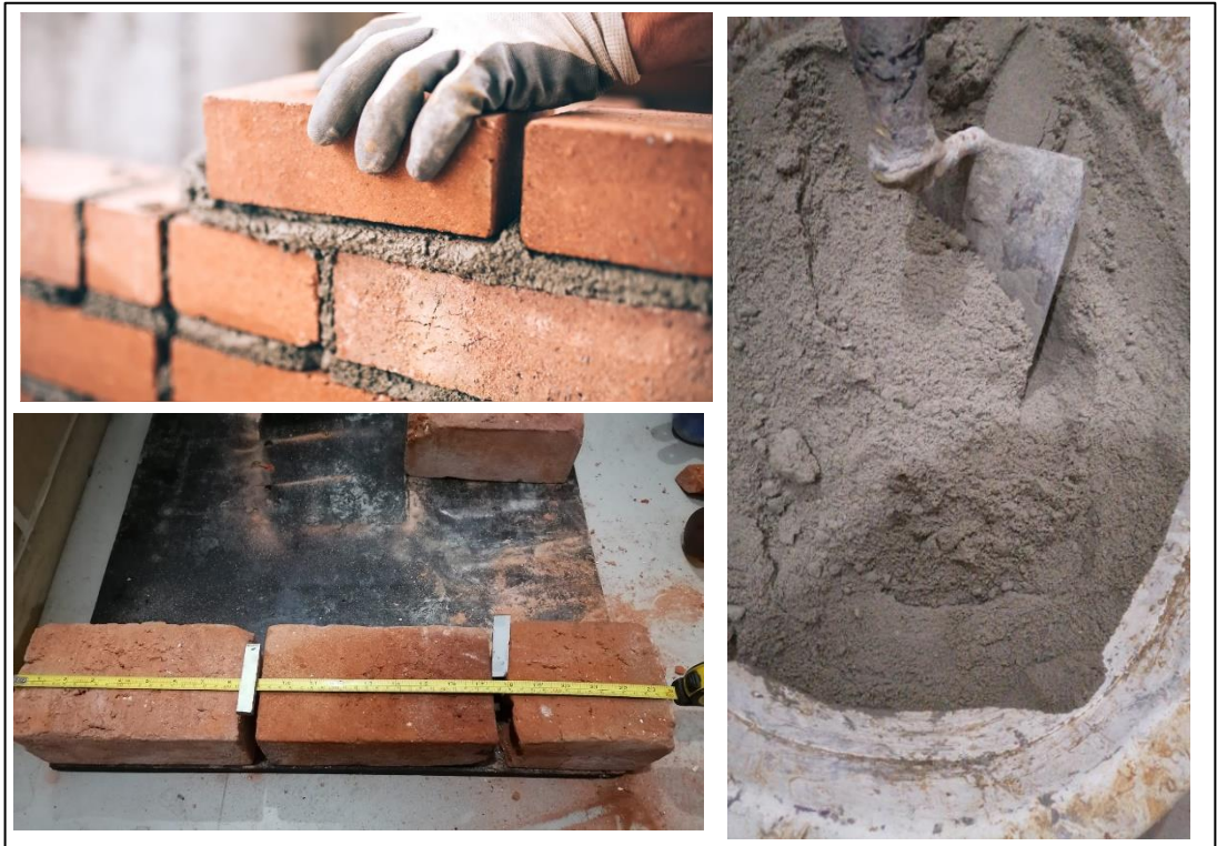
Figura 37. Elaboración de pilas de ladrillo
