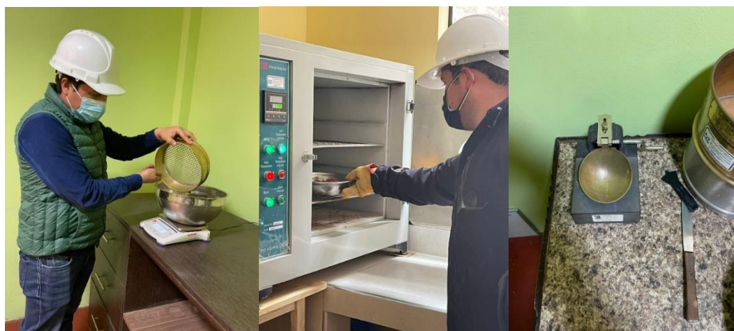
Figura 31. Granulometría Arcilla y horneado de la muestra
