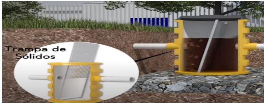
Figura N°4: Trampa para sólidos
