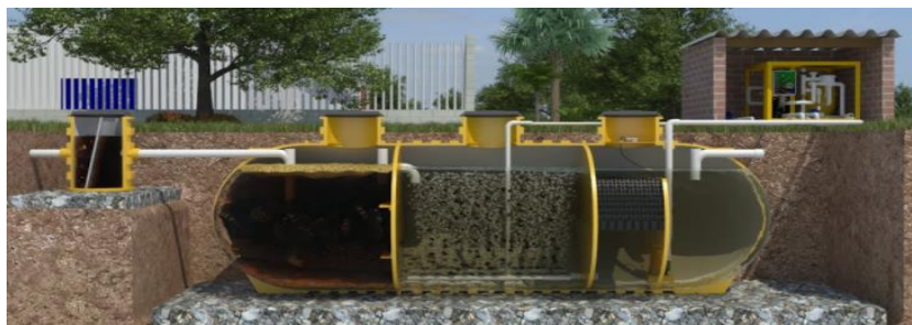
Figura N°8: planta de tratamiento de agua residuales
