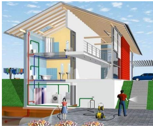
Figura N°9: red de distribución de agua tratada en una vivienda multifamiliar
