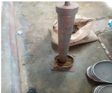
Imagen 13. Vista pisón del proctor modificado
