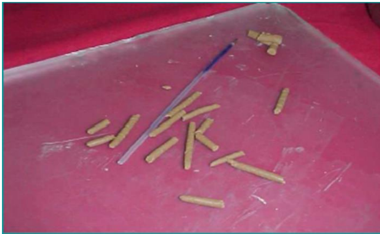
Figura 12. Rollitos Límite Plástico
