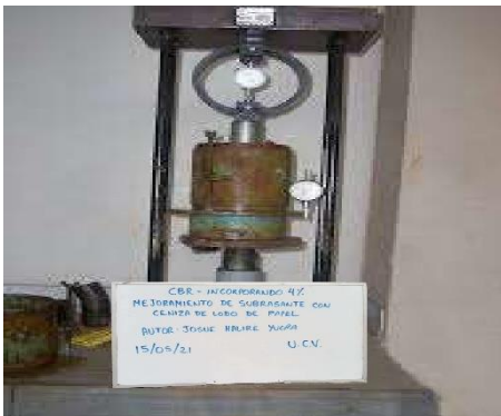
Imagen 19. Vista del equipo CBR con 4% de ceniza
