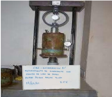
Imagen 17. Vista de equipo CBR con 8% de ceniza
