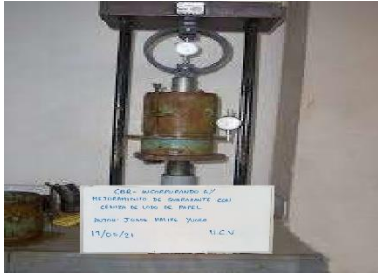
Imagen 9. Vista de equipo CBR con 6% ceniza
