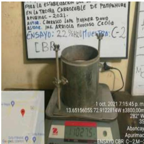
Fotografía: De ensayo CBR de la muestra natural c-2
