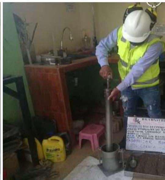
Fotografía: De ensayo CBR de la muestra más 18% de C.C.
