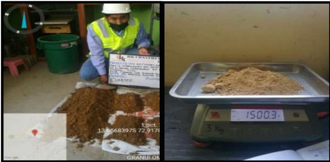
Figura 3: Cuarteo de Análisis Granulométrico calicata C-2
