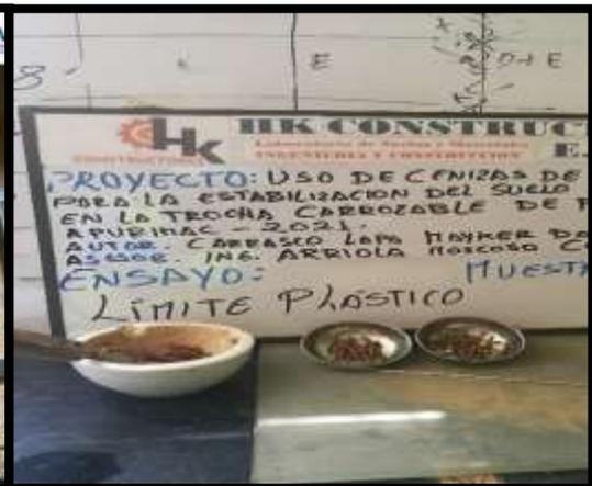
Figura 6: Ensayo limite plástico calicata C-1
