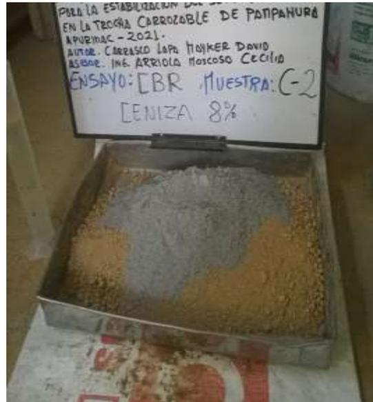
Fotografía: De ensayo CBR de la muestra más 8% de C.C.
