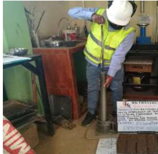
Fotografía: De ensayo proctor modificado de la muestra más 8% de C.C.
