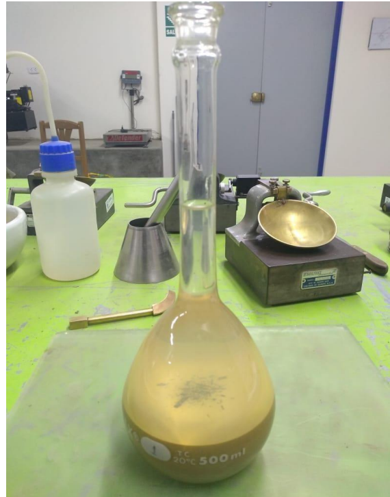
Fotos 4: En la izquierda limite plástico y limite líquido y la derecha peso específico.
