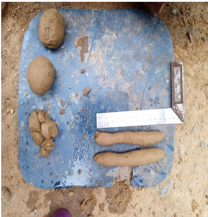
Fotos 2: Prueba de la cinta de barro, prueba de la resistencia seca y prueba de la botella.
