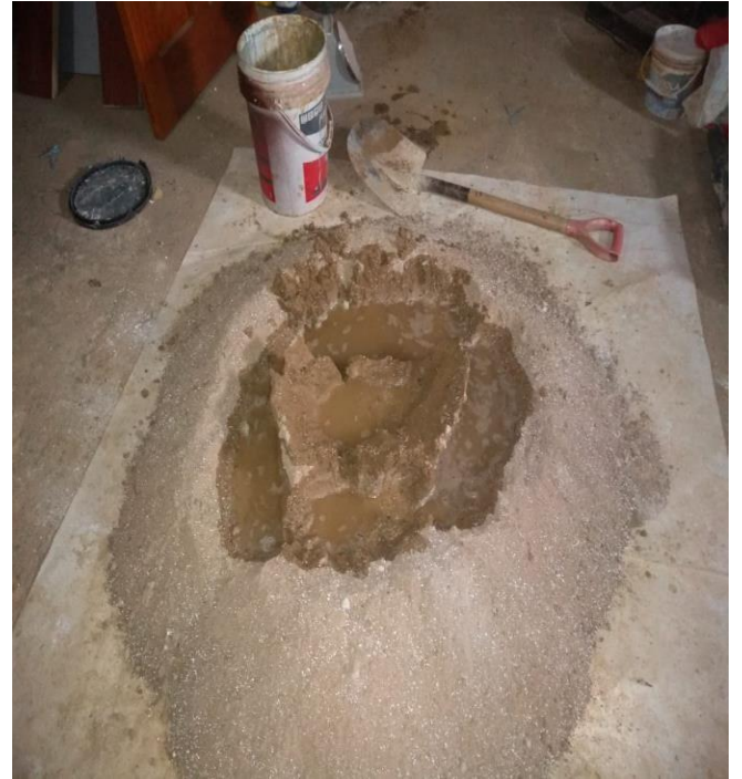
Fotos 5: suelo común + relave minero y + cal mezcladas homogéneamente.
