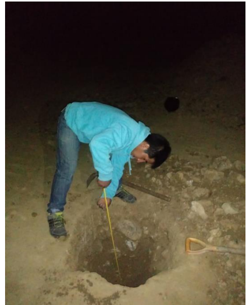
Fotos 1: Reconocimiento del terreno y realizar calicata para el estudio de suelos.
