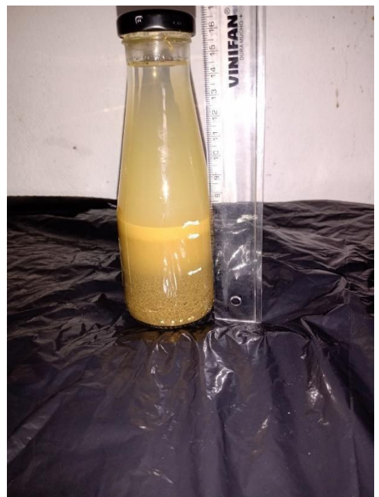
Fotos 2: Prueba de la cinta de barro, prueba de la resistencia seca y prueba de la botella.
