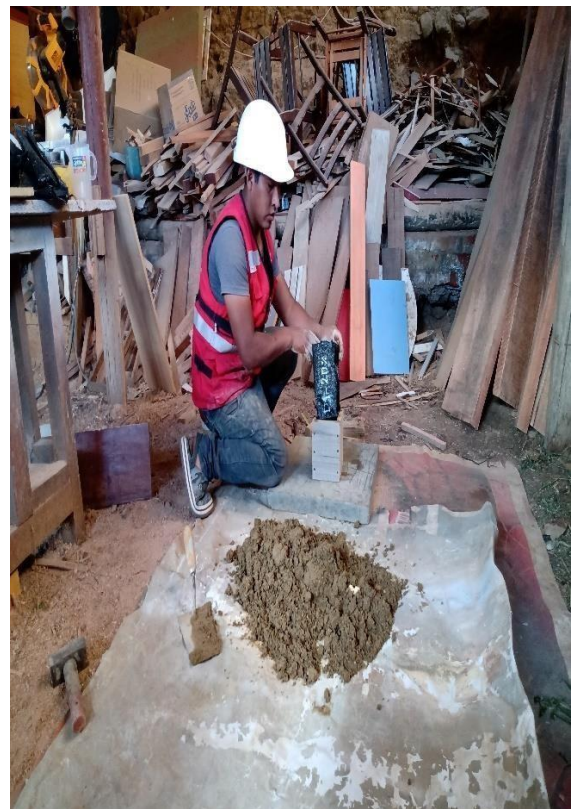
Fotos 5: suelo común + relave minero y + cal mezcladas homogéneamente.
