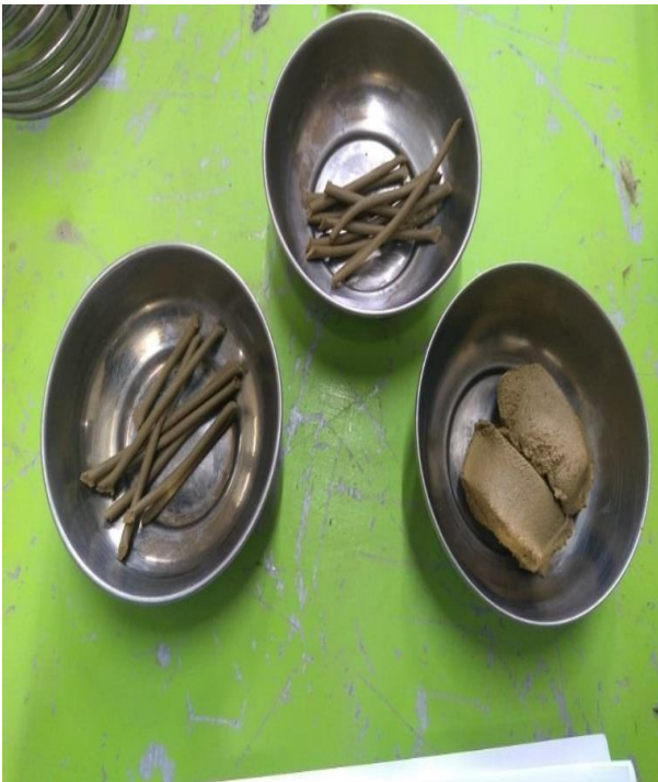
Fotos 4: En la izquierda limite plástico y limite líquido y la derecha peso específico.
