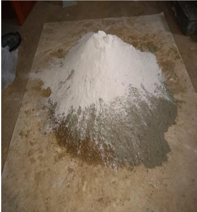
Fotos 5: suelo común + relave minero y + cal mezcladas homogéneamente.
