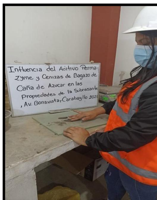
Figura 21: Ensayo del Limite Plástico
