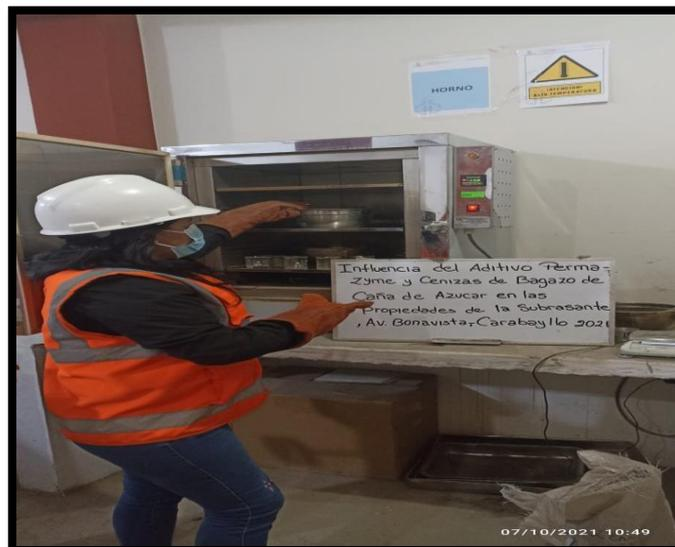
Figura 26: Muestra ingresada al horno de secado
