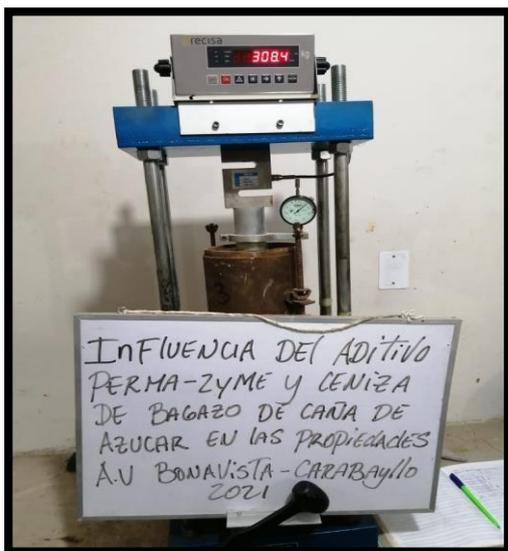
*Figura 32: Ensayo de CBR*
