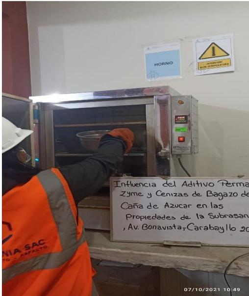
Muestra retirada del Horno de seca
