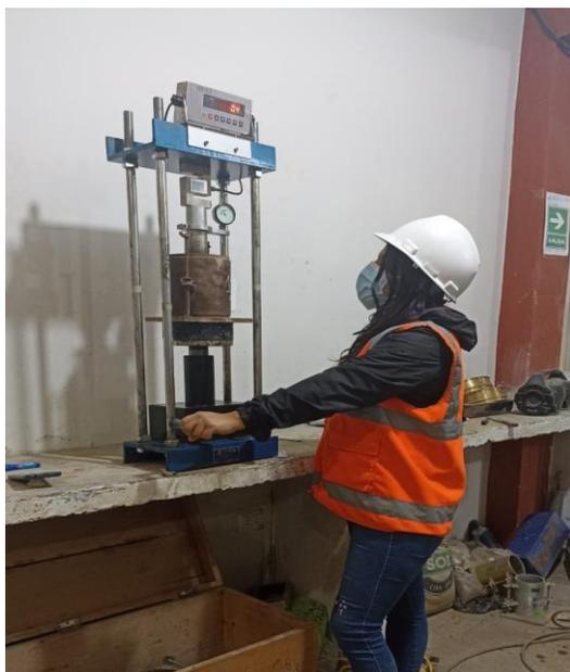
Penetración de Energía Modificada
