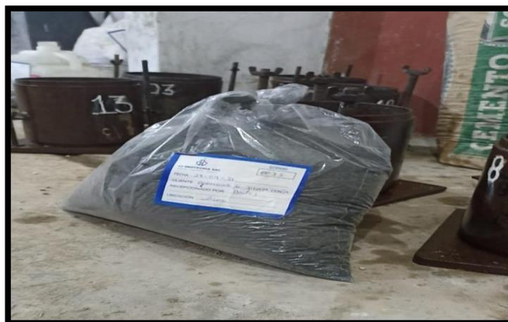
*Figura 4:* Cenizas del bagazo de caña de azúcar
