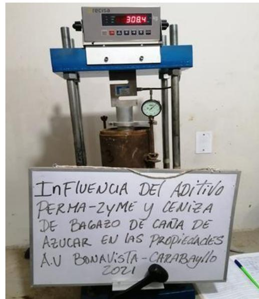
Prensa para ensayo de CBR para
