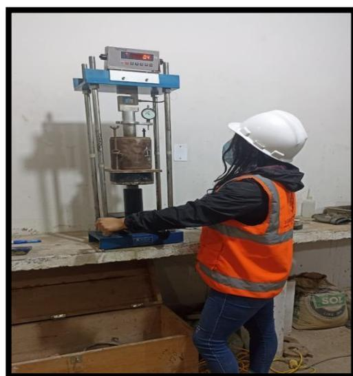
*Figura 33: Penetración de la muestra*
