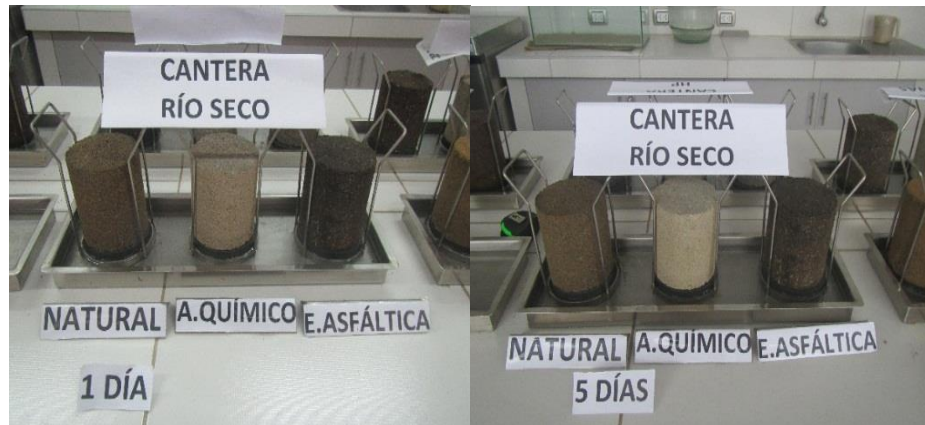
Figura 6: Ensayo de ascensión capilar de material granular natural a 1 día y 5 días
