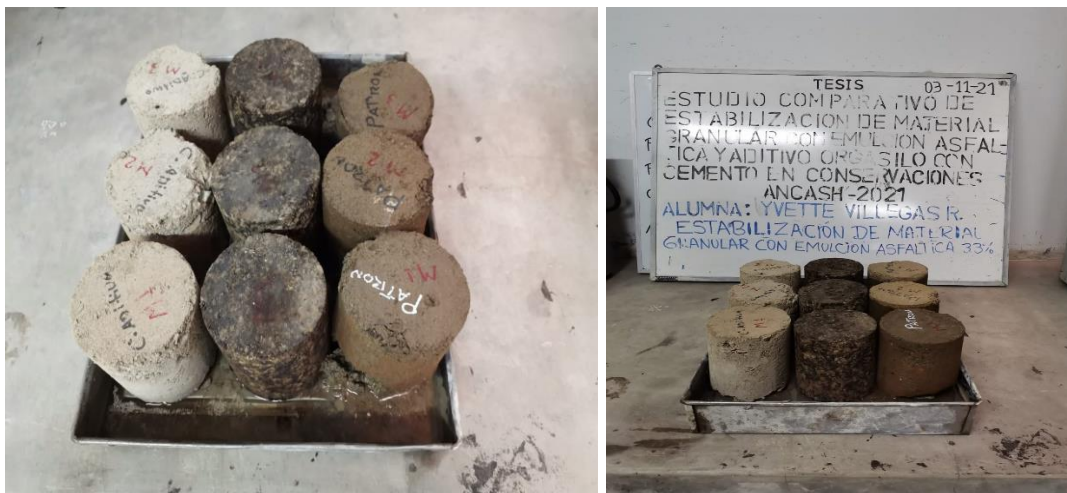
Figura 14: Ensayo de absorción por capilaridad y ascensión capilar de material granular natural y estabilizado con emulsión asfáltica y aditivo organosilado con cemento
