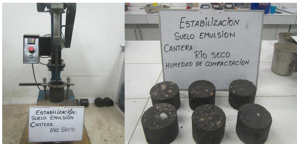
Figura 9 : Determinación de humedad de compactación
