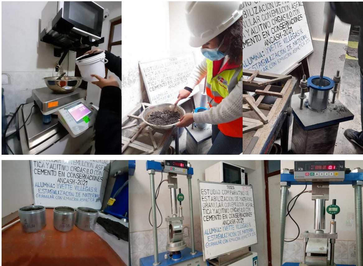
Figura 15: Proceso de elaboración de testigos y ensayo Marshall para determinar estabilidad Marshall de material granular estabilizado con 3.3 % de emulsión asfáltica
