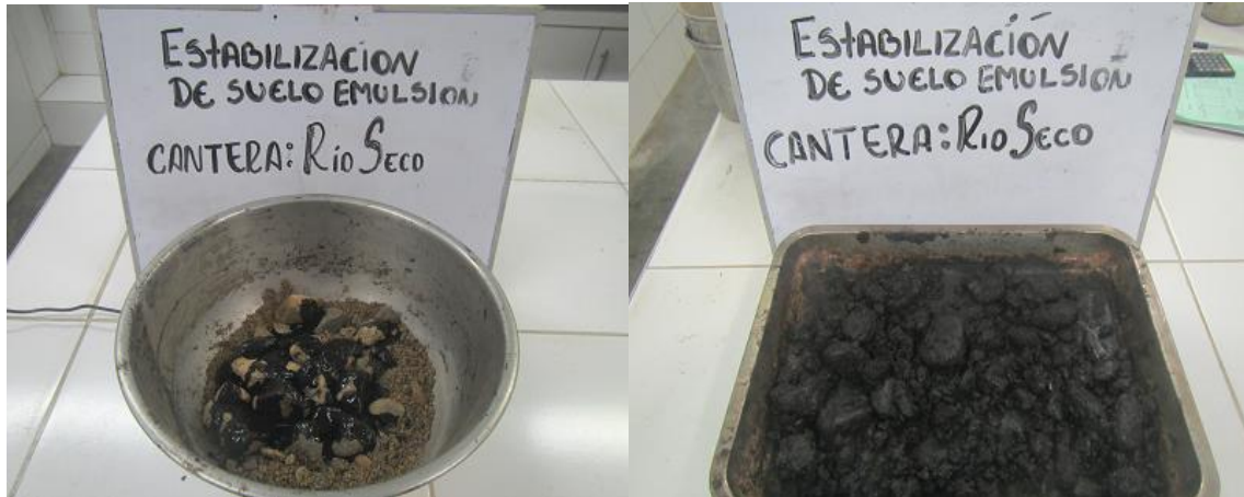
Figura 8: Ensayos de ensayos de recubrimiento para determinar el cantidad aproximada de emulsión asfáltica
