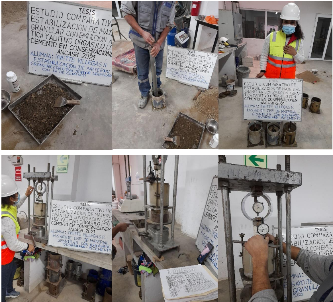
Figura 17: Ensayo de CBR de material granular estabilizado con 0.75 l/m 3 de aditivo organosilano con 1% de cemento
