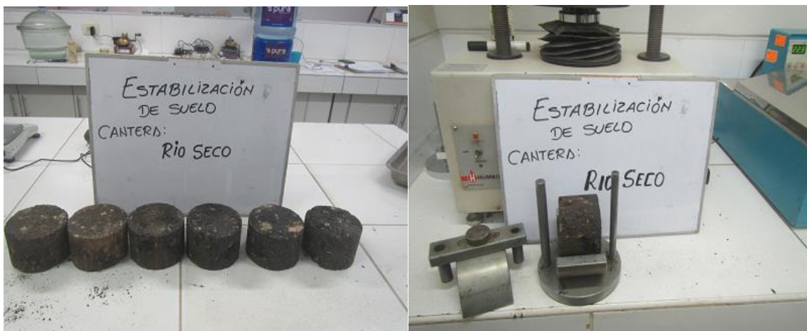
Figura 11: Ensayos de las a los especímenes suelo emulsión para determinar la variación de contenido de asfalto
