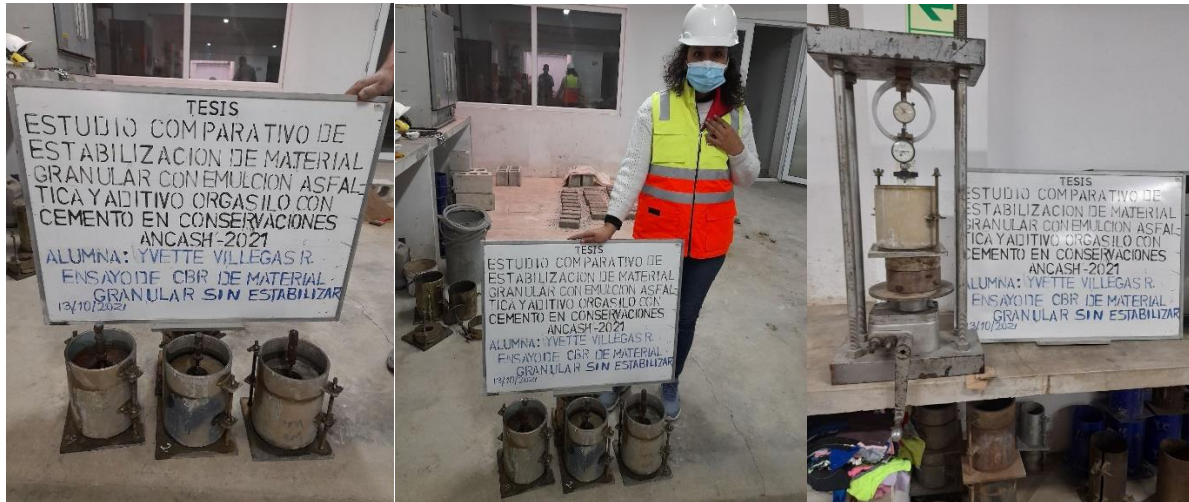
Figura 4: Caracterización y evaluación de las propiedades físicas y mecánicas de material granular
