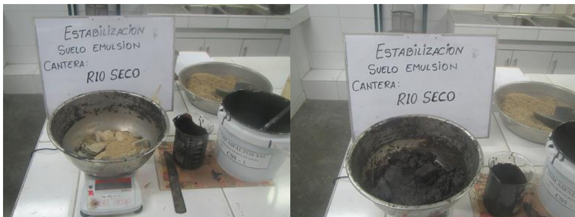
Figura 10: Preparación de especímenes suelo emulsión para determinar la variación de contenido de asfalto
