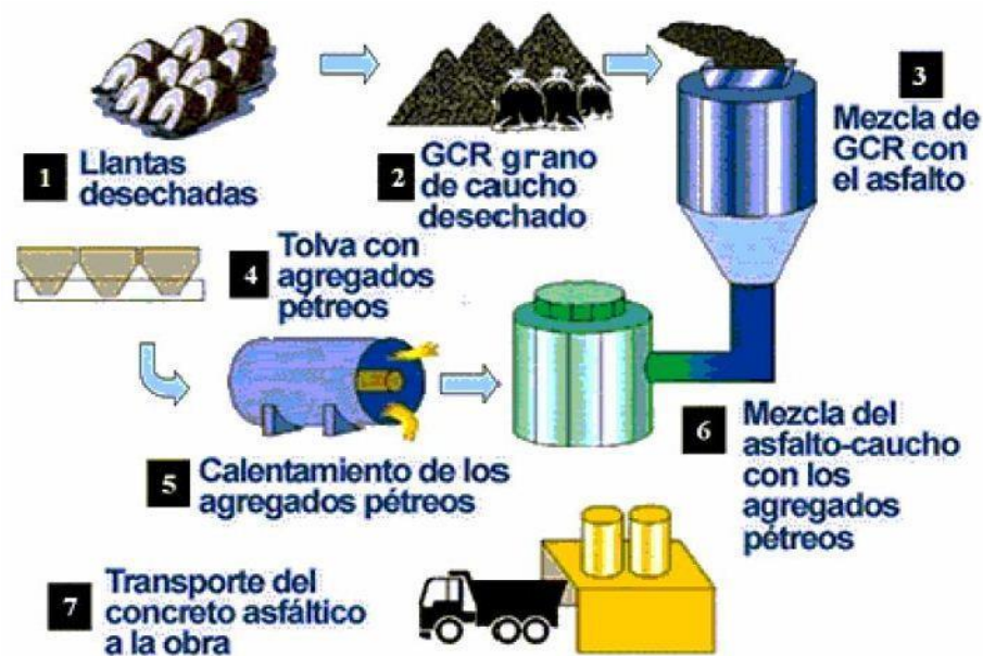
Figura N° 13 Proceso de adición de neumático reciclado vía seca
