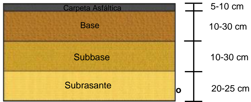
Figura N° 12 CAPAS DE PAVIMENTO (ELABORACIÓN PROPIA).
