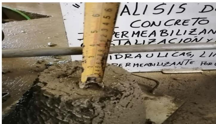
Figura 11. Slump de concreto con impermeabilizante por cristalización
