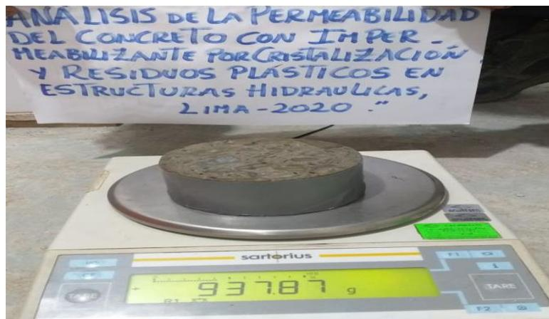
Figura 19. Peso de la probeta sumergida edad 7 días
