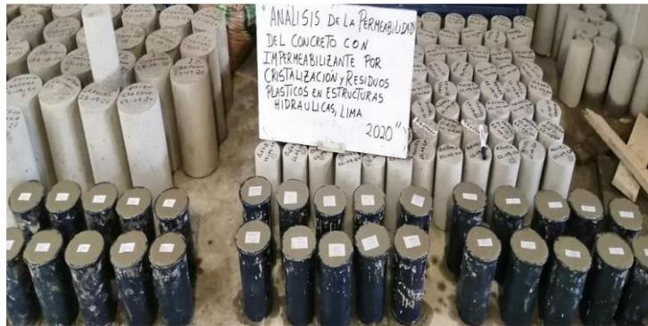
Figura 13. Especímenes patrón y con adición de impermeabilizante por cristalización y residuo plástico PVC 4 x 8 pulg.
