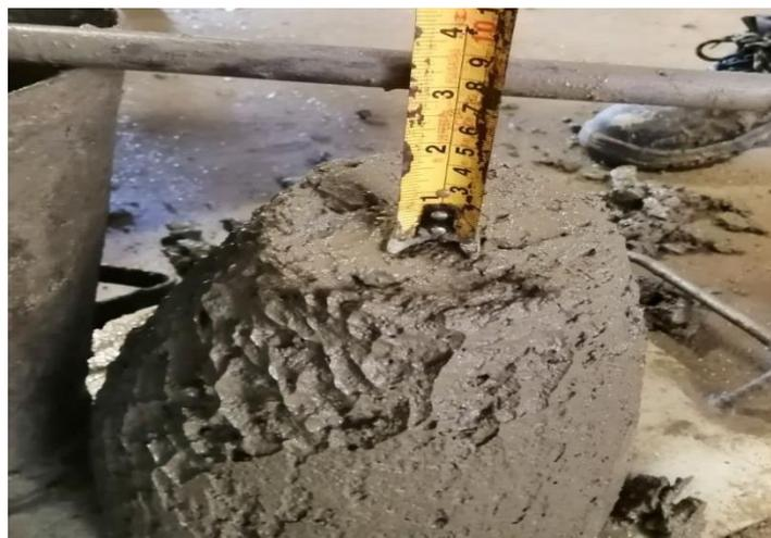
Figura 12. Slump de concreto con residuo plástico PVC
