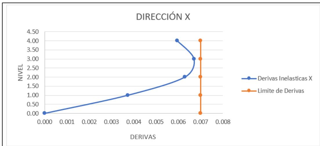
**Tabla N° 20:** Cálculo de Derivas Inelásticas en Dirección X – Concreto Patrón.
