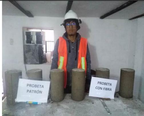
*Figura 40.* Probetas cilíndricas de concreto
