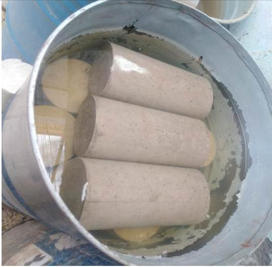
*Figura 41.* Se realiza curado sumergido de concreto
