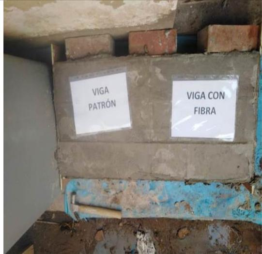
*Figura 42.* Probetas prismáticas de vigas de flexión.
