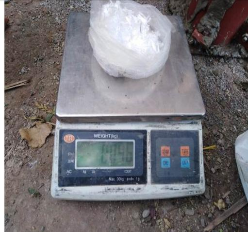
*Figura 28.* Pesaje de microfibra de polipropileno
