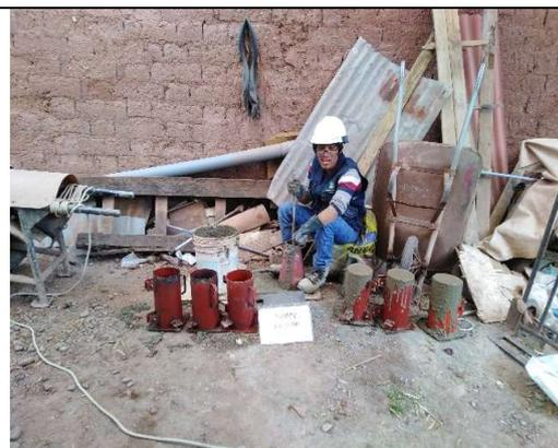
*Figura 32.* Elaboración de ensayo de Abrams
