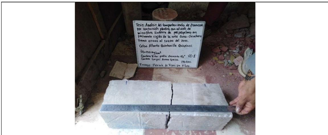
Figura 19. Falla de viga de flexión
