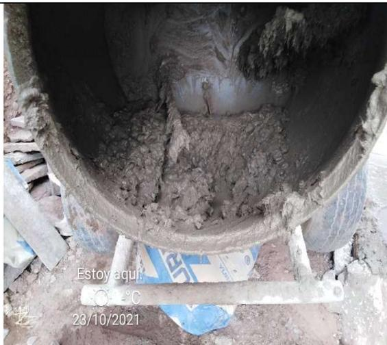
**Figura 35.** Se aprecia conglomeración de fibra en mezclado
