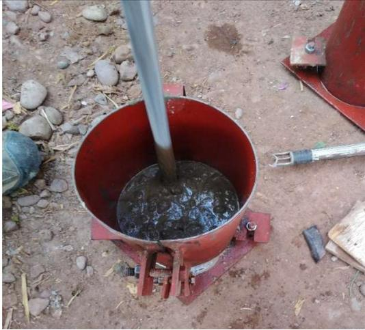
*Figura 37.* Se realiza vaceado de probetas cilíndricas
