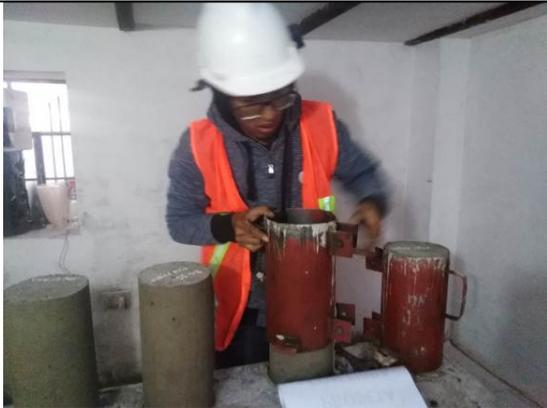
*Figura 39.* Se realiza desmoldado de probetas
