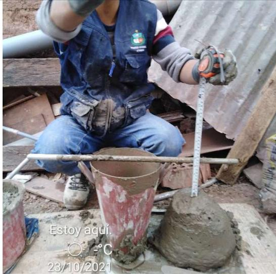
**Figura 33.** Toma de medidas de prueba de Slump
