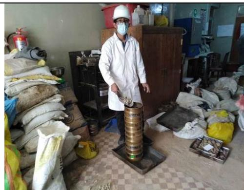
*Figura 26.* Tamizado de materiales de cantera
