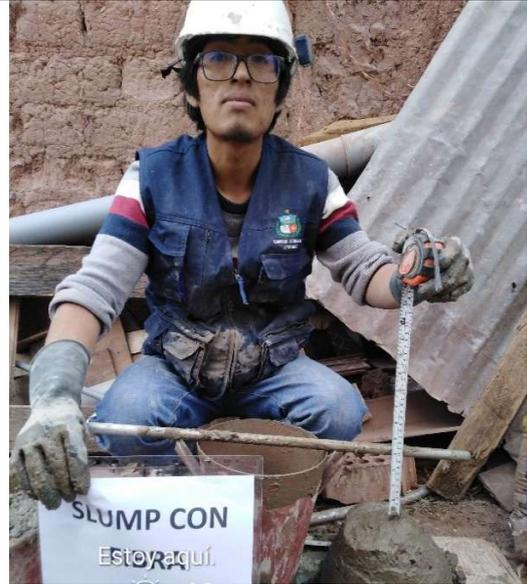
**Figura 34.** Toma de medidas de prueba de Slump
