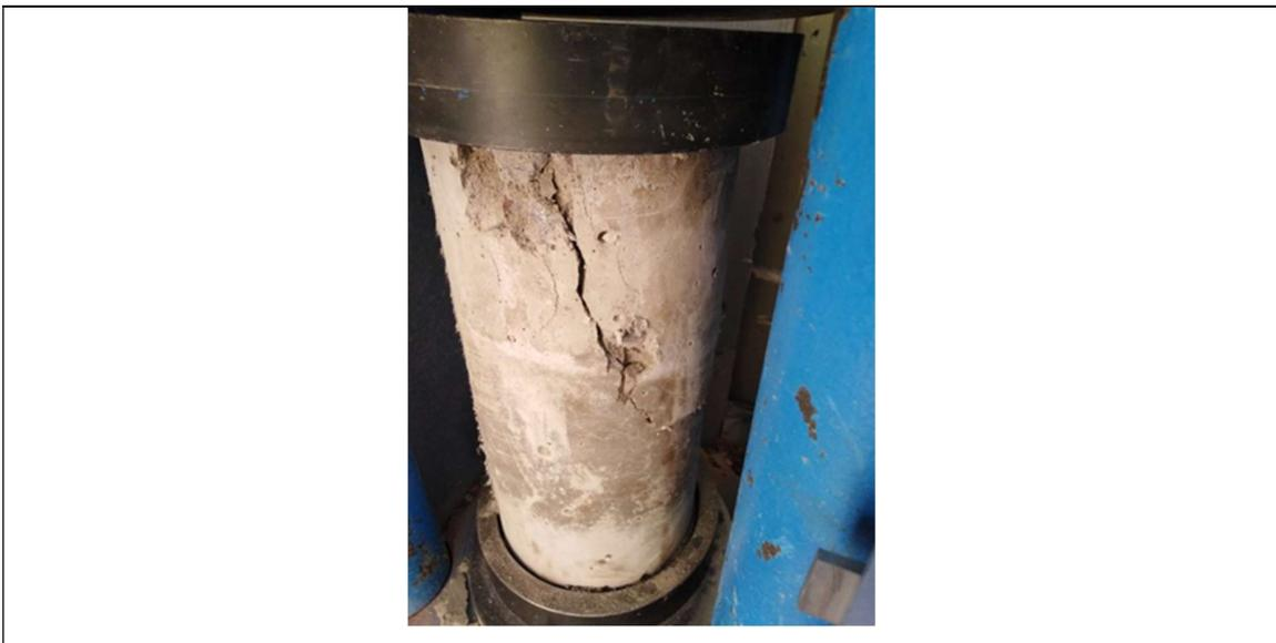
*Figura 17.* falla de probeta cilíndrica a compresión
