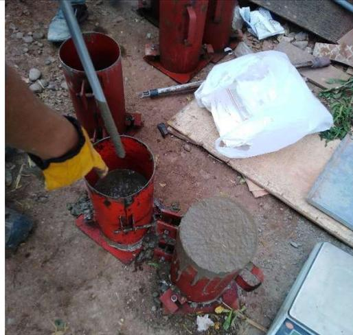
*Figura 38.* Se realiza varillado por capas en probetas cilíndricas.
