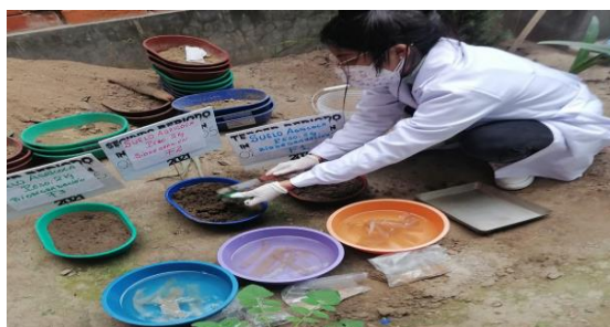
Figura N°52. Biodegradación del bioplástico en suelo agrícola y agua de mar
