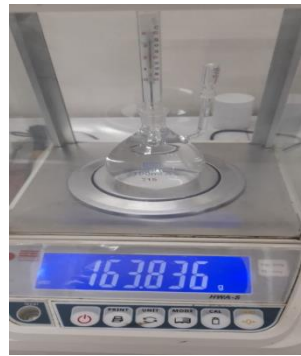
Figura N°32. Peso del picnómetro con agua destilada
