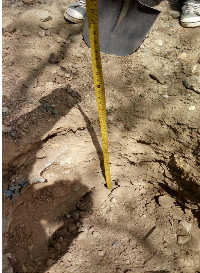
Profundidad de la calicata fue de un 1 metro
