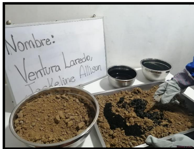
Figura 20. Mezclando el aceite quemado y caucho reciclado con el suelo natural.
