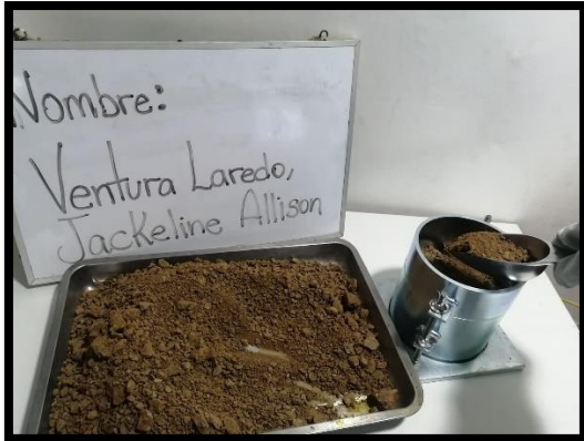
Figura 10. Ensayo Proctor modificado. Figura 11. Proctor modificado C-1
