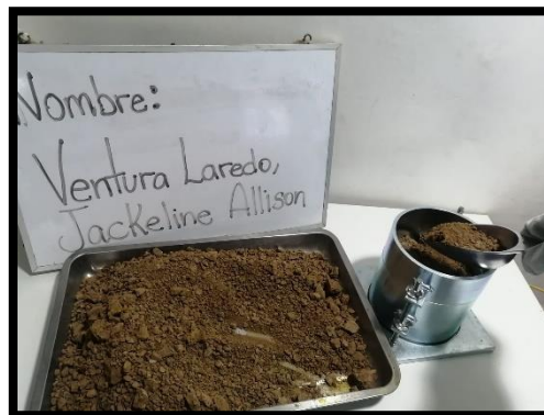
Figura 7. Preparación de la muestra para los especímenes.
