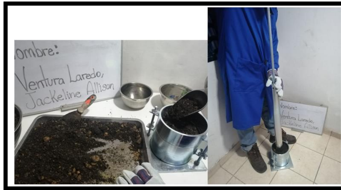
Figura 21. Proceso del Ensayo Proctor modificado
