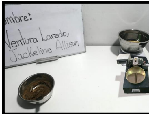
Figura 9. Proceso de ensayo de limite líquido.
