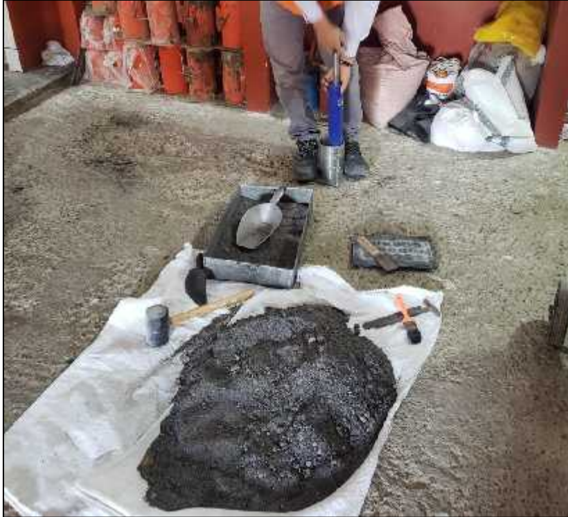
Imagen 12: Realización del ensayo de proctor modificado de la mezcla con el 20% de adición de ceniza de cascarilla de arroz.
