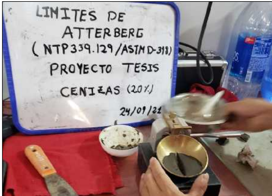
Imagen 14: Ensayo para la obtención del límite líquido de la combinación del 20% de ceniza de cascarilla de arroz y suelo natural con el uso de la copa Casa Grande.
