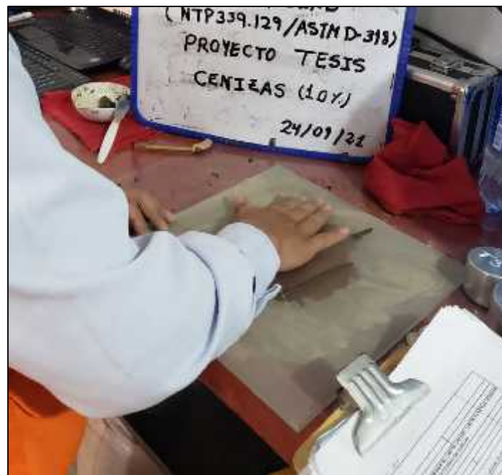
Imagen 15: Ensayo para la obtención del límite plástico con la realización de cilindros.
