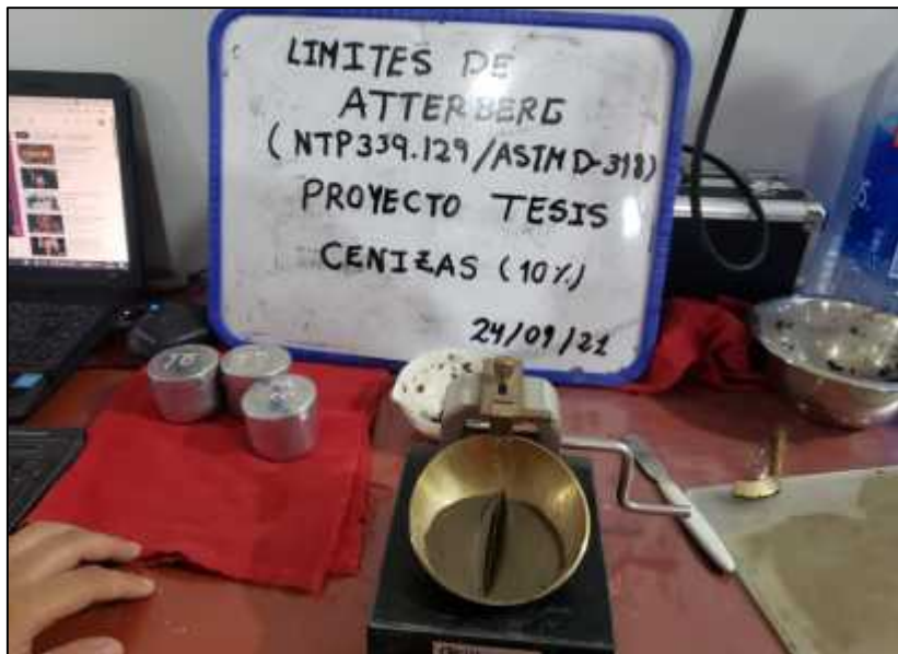
Imagen 13: Ensayo para la obtención del límite líquido de la combinación del 10% de ceniza de cascarilla de arroz y suelo natural con el uso de la copa Casa Grande.
