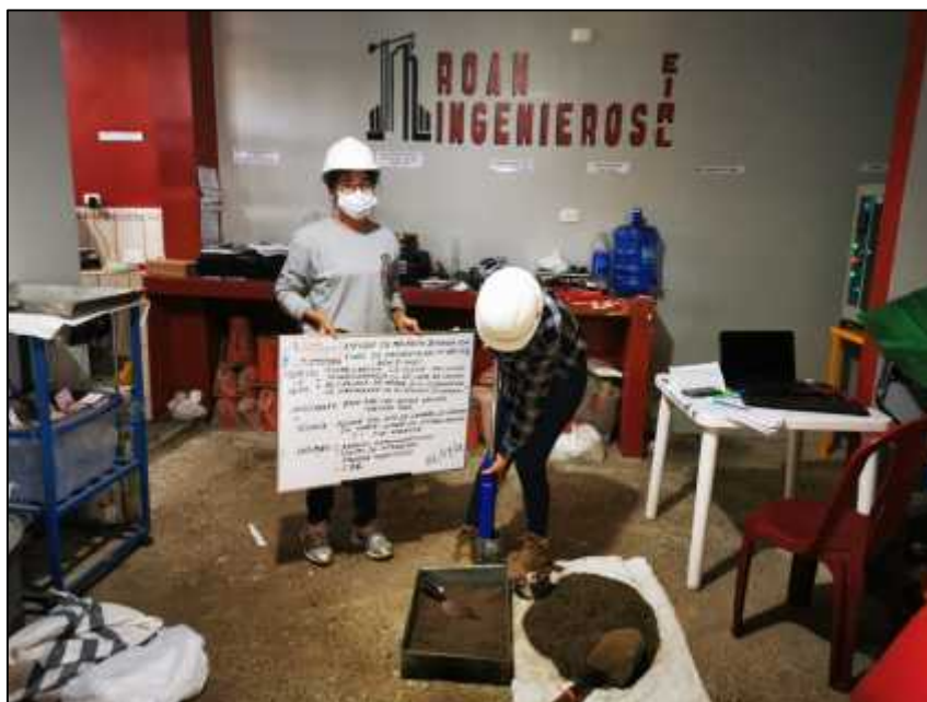
Imagen 11: Realización del ensayo de proctor modificado de la mezcla con el 10% de adición de ceniza de cascarilla de arroz.
