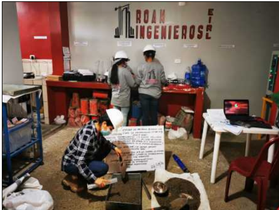
Imagen 10: Preparación de la muestra para el ensayo respectivo de Proctor Modificado de la combinación del 10% de ceniza de cáscara de arroz y muestra natural.
