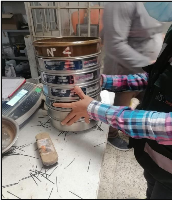
Tamizado y determinación del peso unitario de los agregados.
