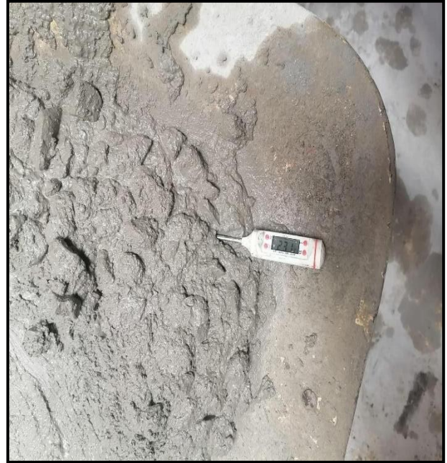
Preparación de la muestra para el asentamiento (Slump) y medición de la Temperatura
