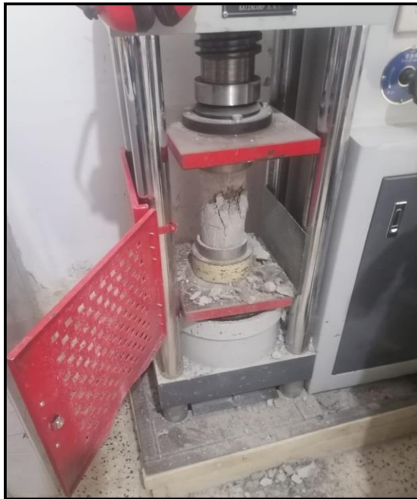
Rotura de las probetas 0.5%, 1.5% y 2.5% de CBCA
