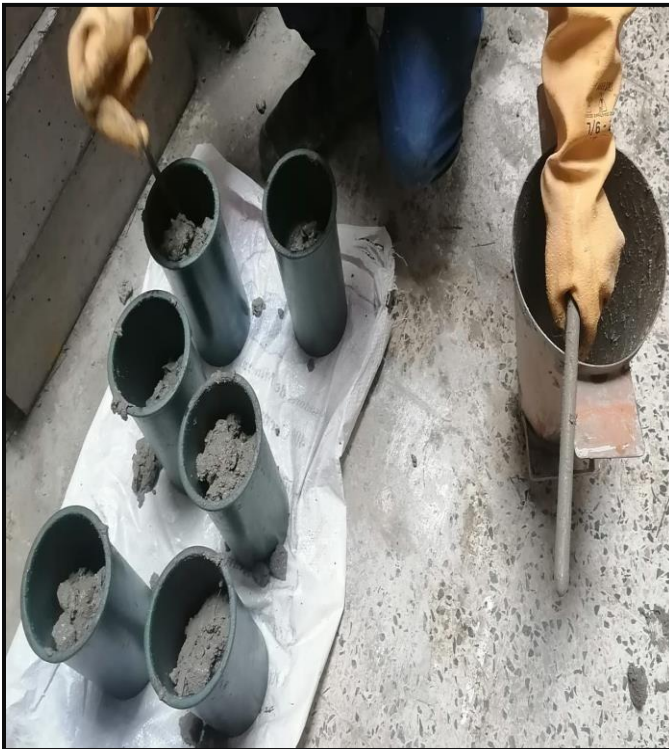
Llenado y compactado de la mezcla a los moldes.
