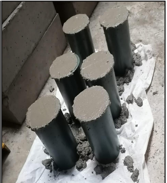
Llenado y compactado de la mezcla a los moldes.
