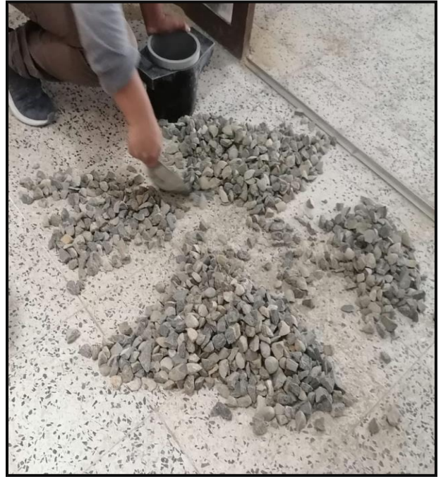
Cuarteo de los agregados para el análisis granulométrico.
