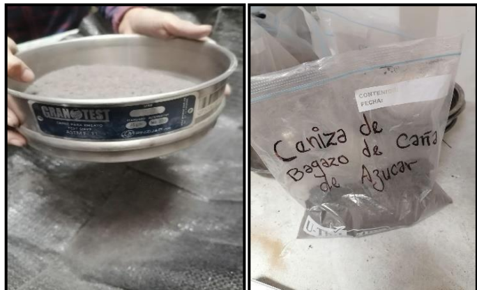
Foto 08: CBCA lista para los ensayos de mezcla de concreto.
