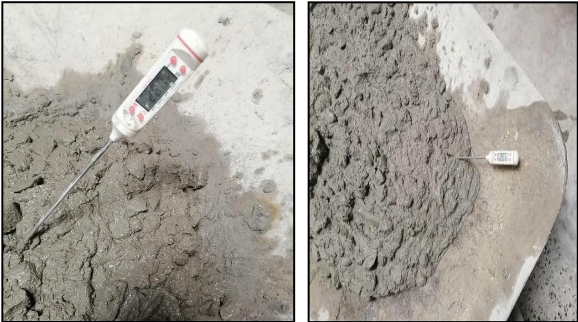
Medida de la temperatura de la mezcla de concreto con CBCA
