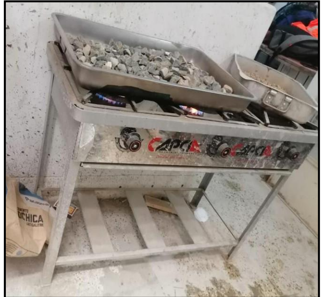
Peso y secado de los agregados
