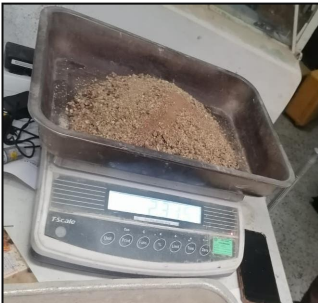
Peso y secado de los agregados
