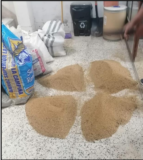
Cuarteo de los agregados para el análisis granulométrico.
