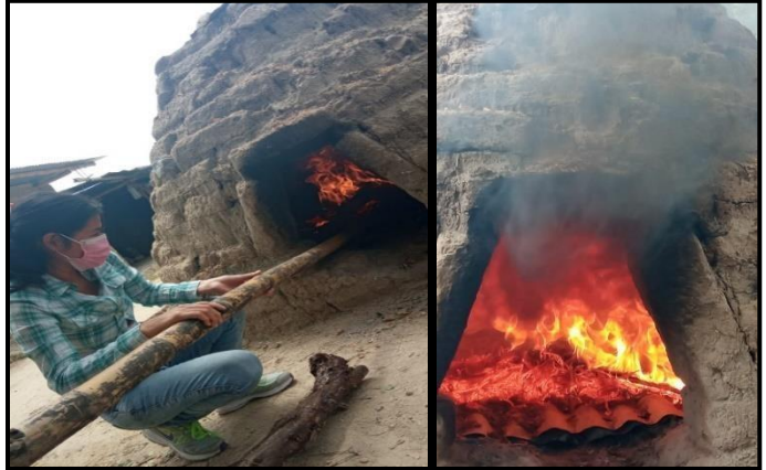
Foto 04: Calcinación del Bagazo de la caña de azúcar
