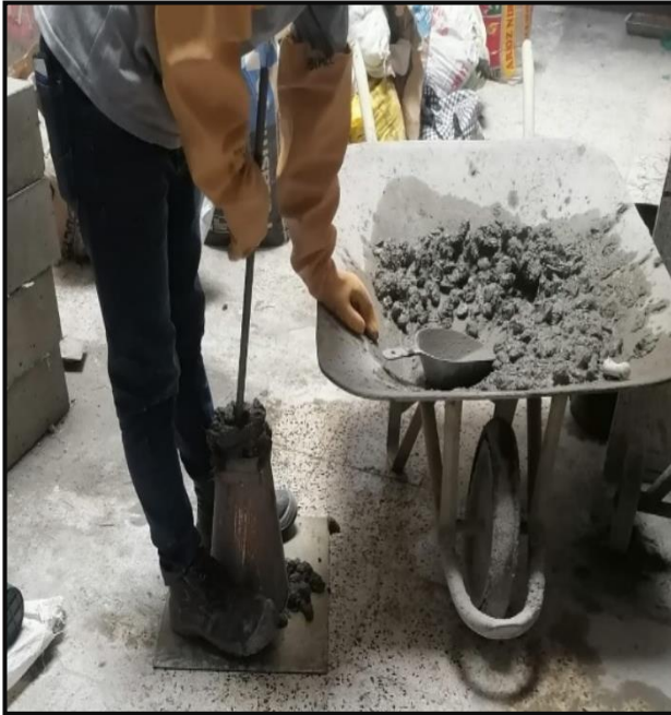
Preparación de la muestra para el asentamiento (Slump) y medición de la Temperatura
