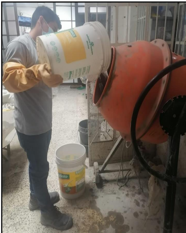
Preparación de la mezcla sin CBCA para la elaboración de las probetas.
