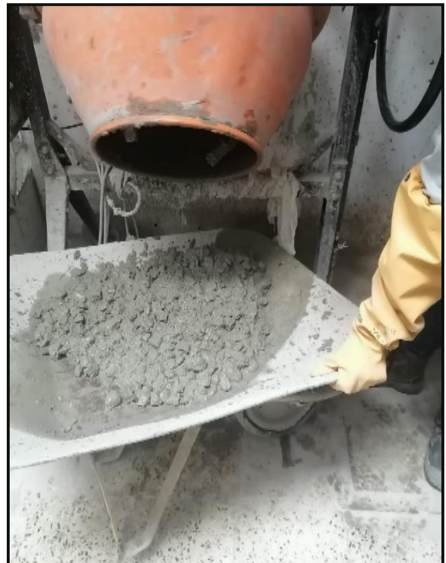
Preparación de la mezcla sin CBCA para la elaboración de las probetas.
