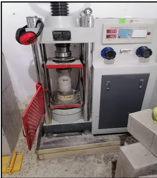
Rotura de probetas 0 % de CBCA a los 7, 14 y 28 días – Mezcla convencional
