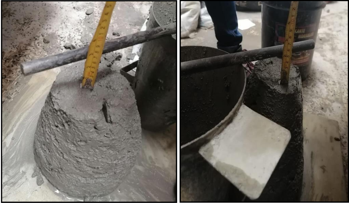
Medida del Slump de las mezclas de concreto con CBCA
