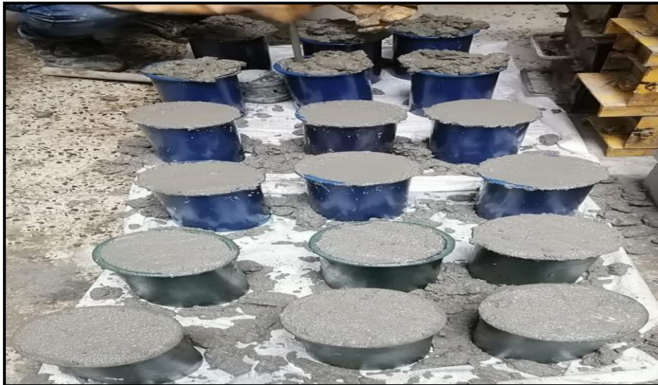
Llenado de la mezcla de concreto con CBCA a los moldes.
