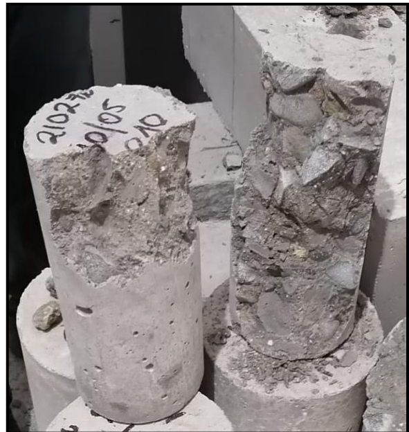
Rotura de probetas 0 % de CBCA a los 7, 14 y 28 días – Mezcla convencional
