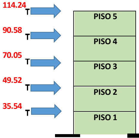
Figura 51. Distribución de fuerzas laterales por piso (X-Y).
