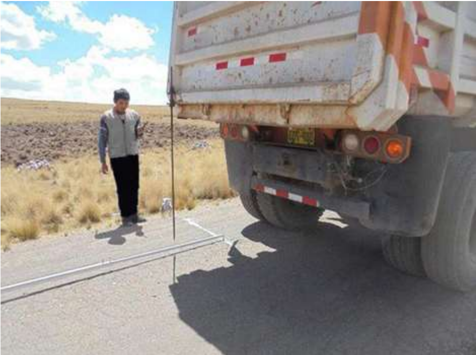
IMAGEN 11: DEFLEXIÓN A 25 CM DEL PUNTO DE ENSAYO.
