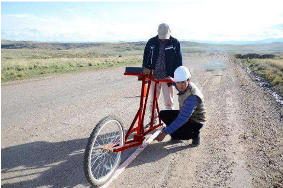
IMAGEN 3: ENSAYO DE ÍNDICE DE RUGOSIDAD INTERNACIONAL (IRI) EN LOS TRAMOS MÁS CRÍTICOS DE LA CARRETERA PUNO – MAÑAZO.
