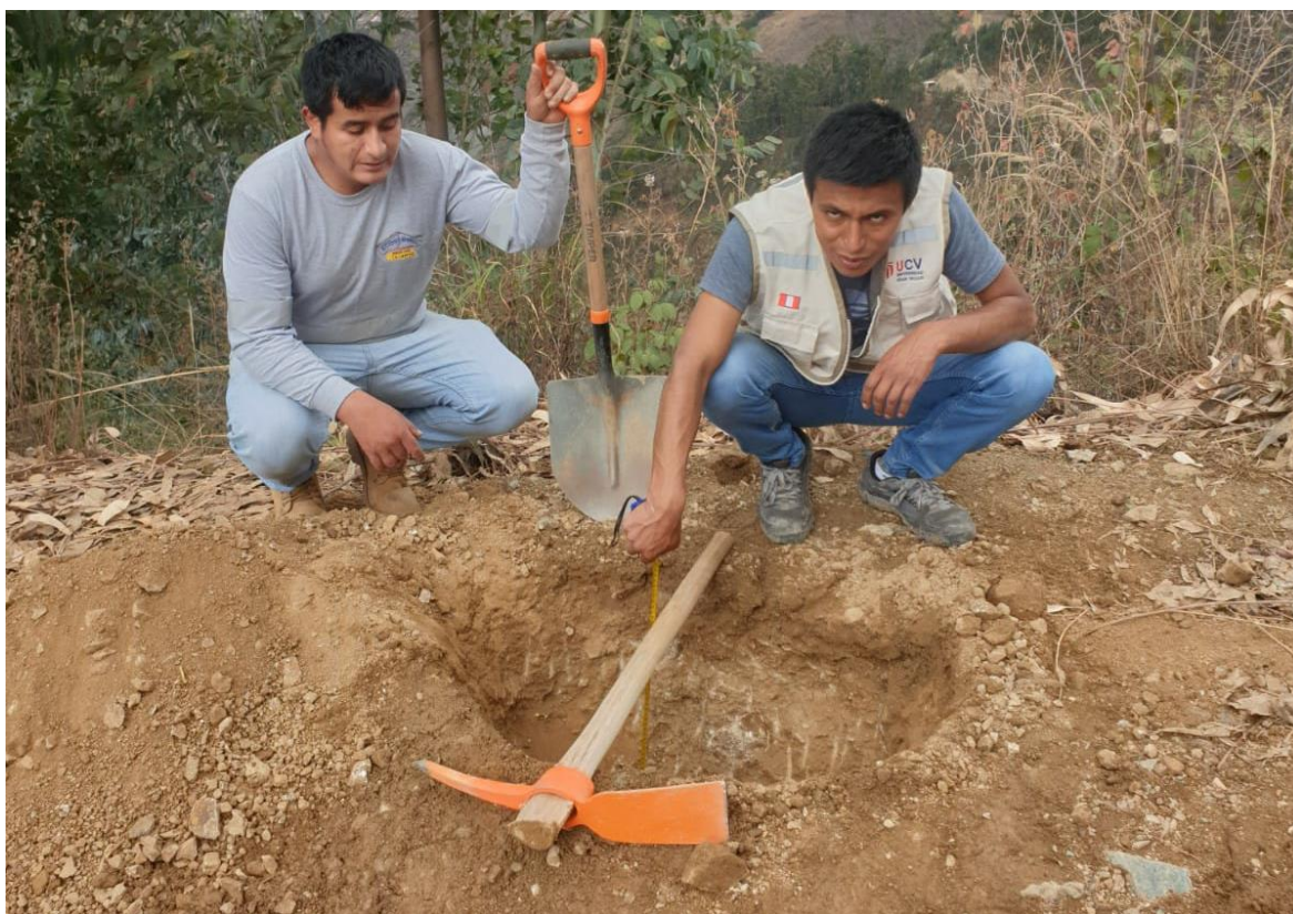
Excavación y extracción de muestras de la calicata N° 06
