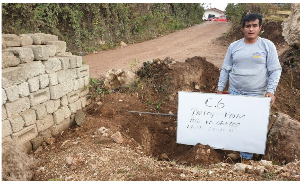
Excavación y extracción de muestras de la calicata N° 06
