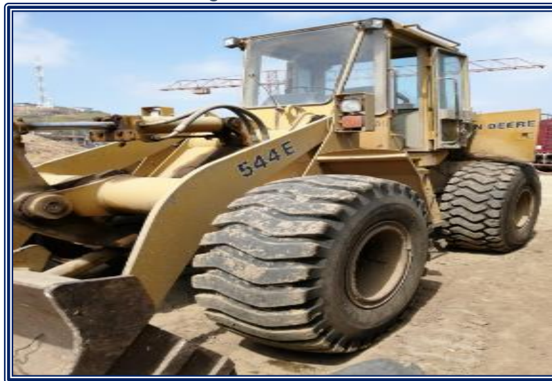
FIGURA 24: Cargador Frontal 544E John Deere
