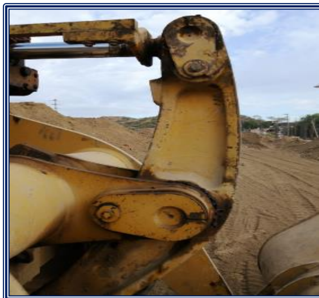
FIGURA 25: Accionamiento de pala y pines
